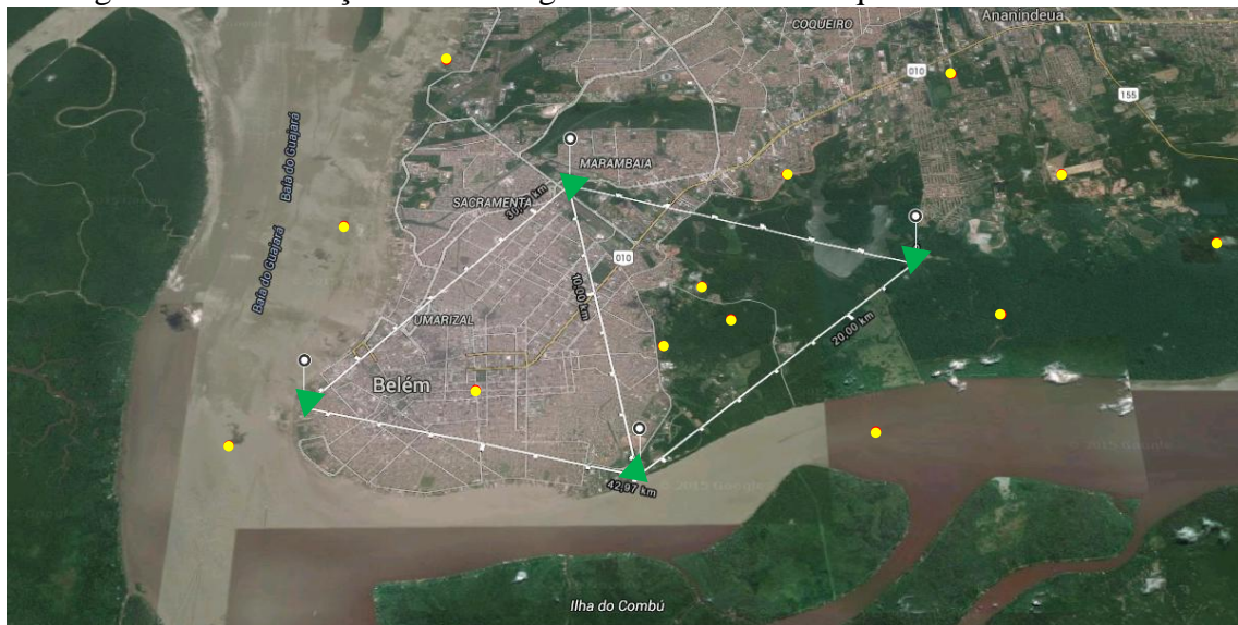
Figura 63. Localização das descargas atmosféricas com quatro sensores na rede.
