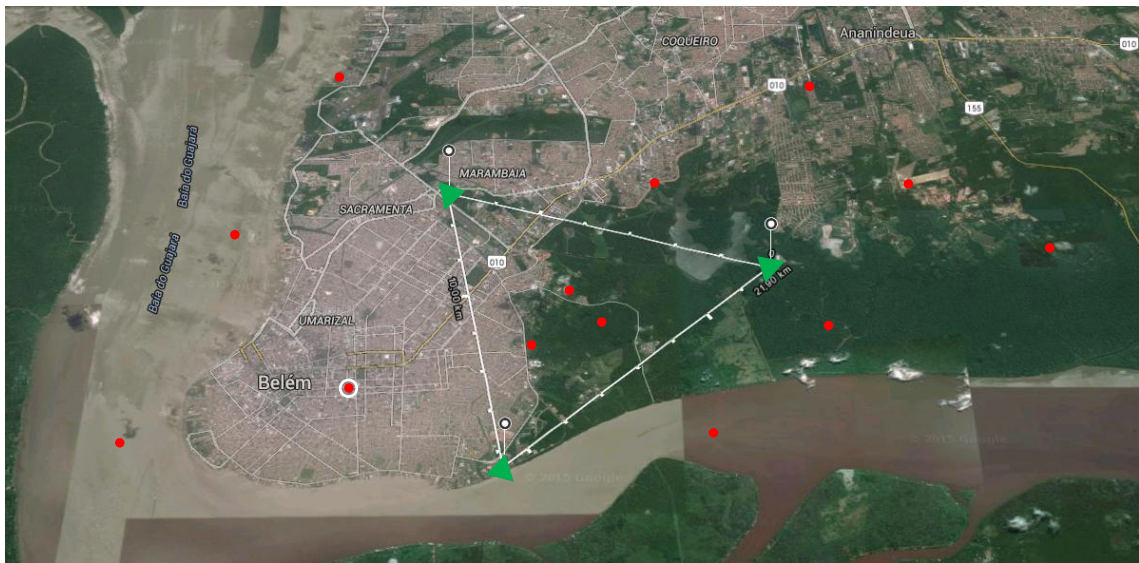
Figura 62. Localização geográfica das descargas atmosféricas para uma rede com três sensores.
