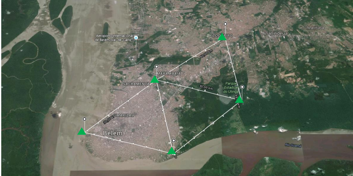
Figura 57. Rede de detecção com cinco sensores em suas distancias mínimas entre eles de 7km.
