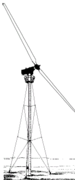
Figura 1.6 – Aerogerador de Hutter de 100 kW, com pás de fibra de vidro (1958) (INGENIERÍA ENERGÉTICA, 2002).
