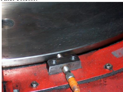
Figura 3.14 Sensor indutivo analógico - Anel coletor.
