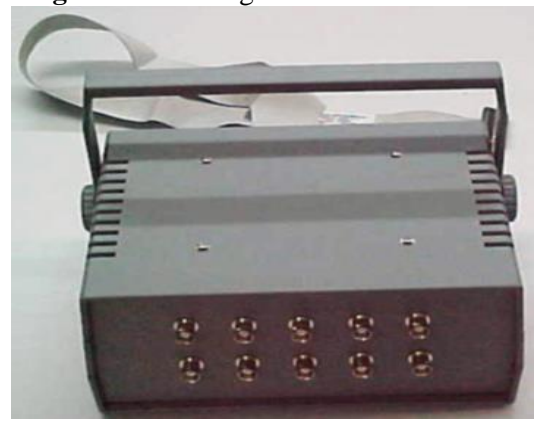
Figura 3.9 Montagem do condicionador.
