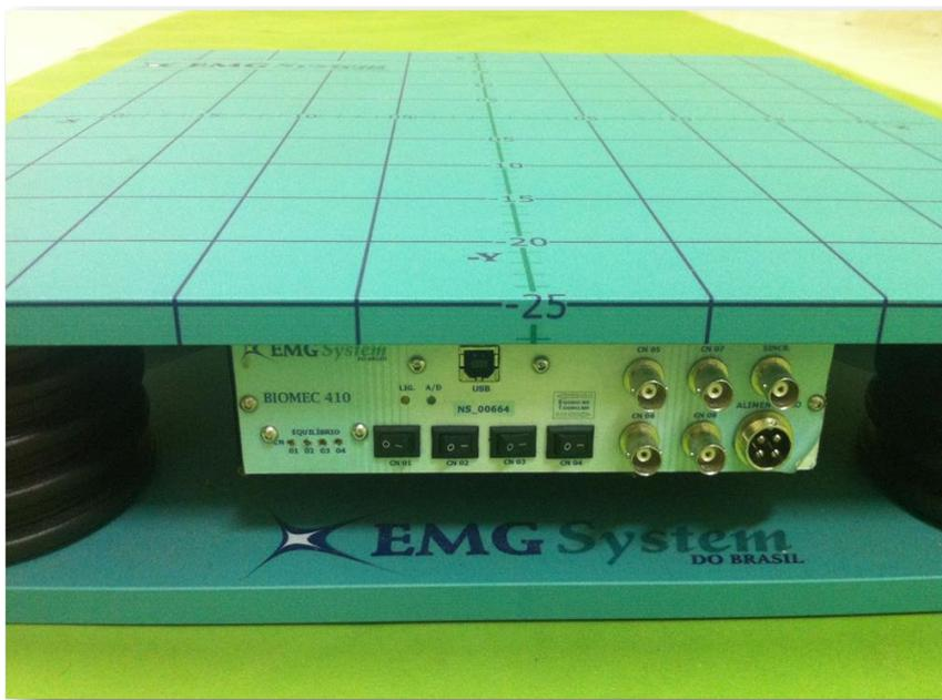
**Figura 4** – Plataforma de força
