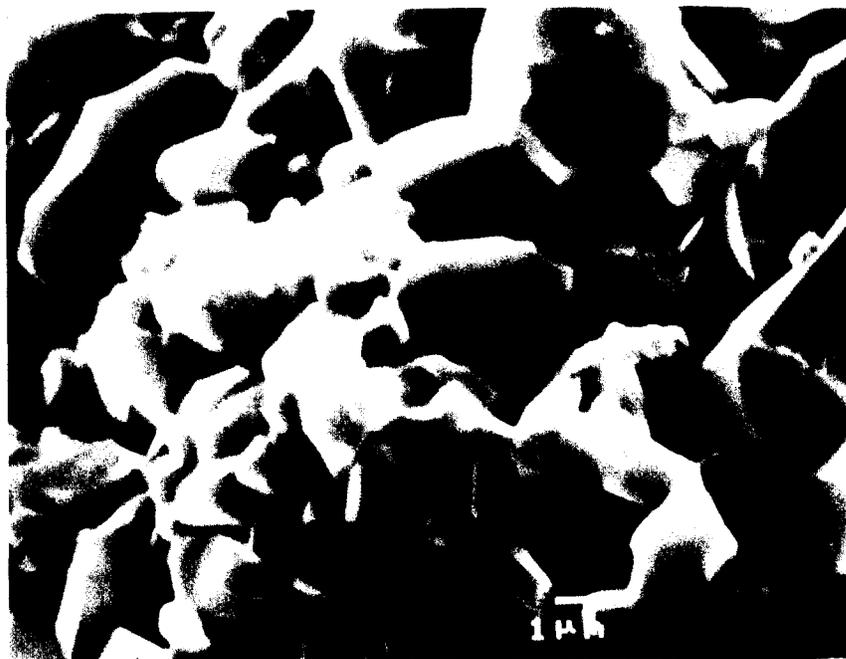
**Figura 5.36** – Micrografia eletrônica de varredura de seção fraturada de corpo de prova da alumina ARK-12, com aumento de 7.500X.
