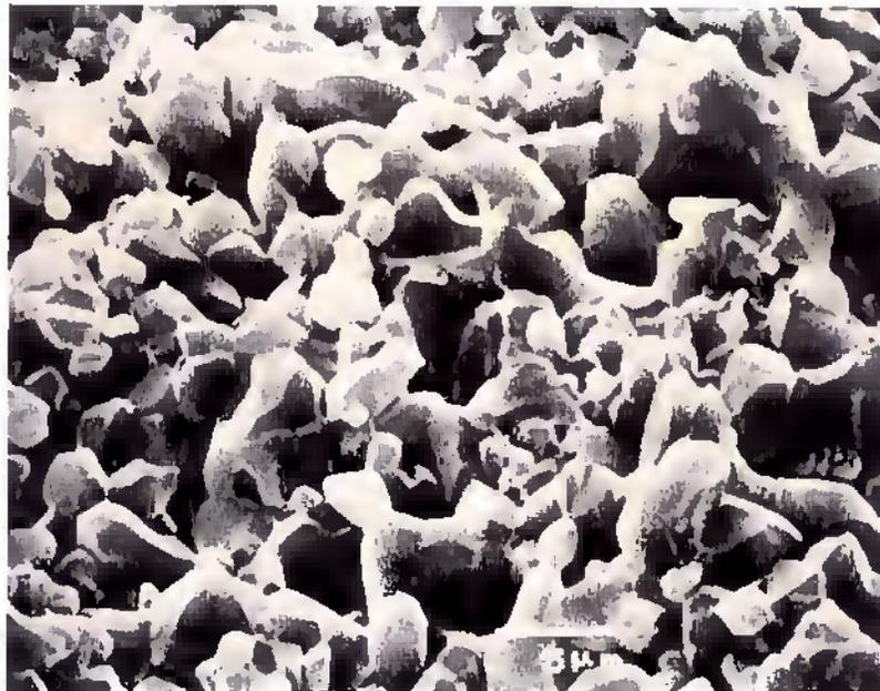
**Figura 5.35** – Micrografia eletrônica de varredura de seção fraturada de corpo de prova da alumina ARK-12, com aumento de 3.500X.
