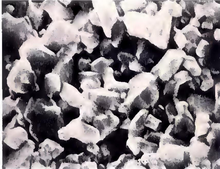
**Figura 5.39** – Micrografia eletrônica de varredura de seção fraturada de corpo de prova da alumina ARKP-12, com aumento de 7.500X.
