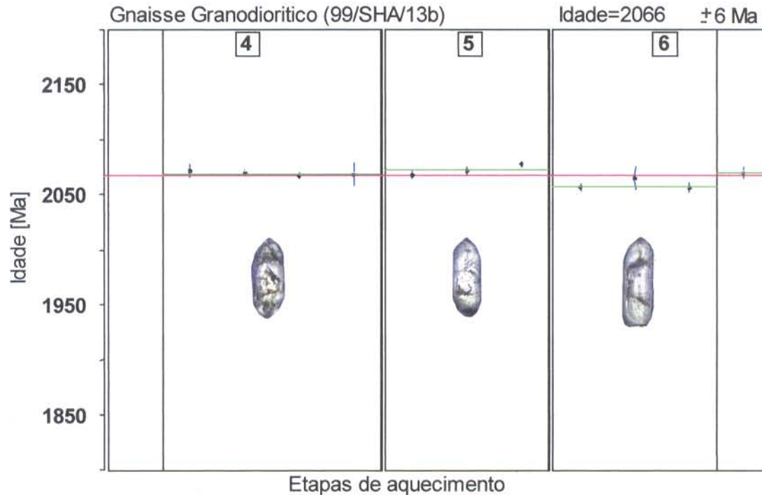
Figura 4.2: Diagrama representando a idade (ordenada) versus etapas de aquecimento (abscissa) para cinco cristais de zircão do gnaiss granodiorítico (99/SHA/13b). ● Blocos de razões ^{207}\text{Pb}/^{206}\text{Pb} utilizados no cálculo estatístico da idade.
