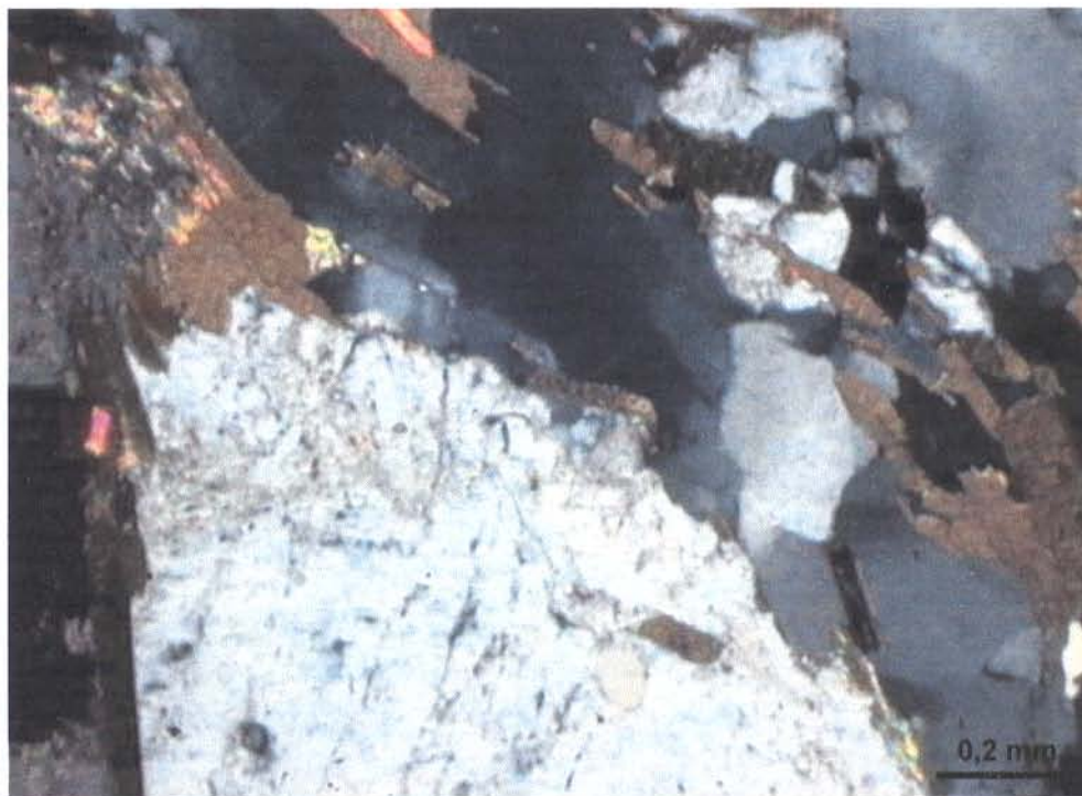
Figura 3.24: Fotomicrografia do gnaiss monzogranítico (99/SHA/22) mostrando finos níveis contendo biotita orientada amoldando-se a fenocristal de feldspato microfraturado.
