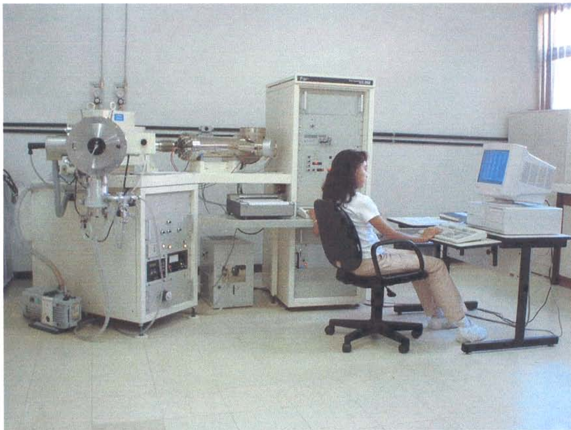
Figura 1.7: Espectrômetro de Massa FINNIGAM MAT, modelo 262 do Laboratório de Geologia Isotópica (Pará-Iso) – UFPA.
