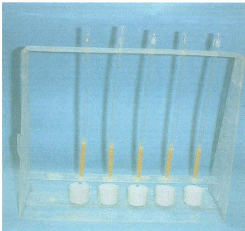
Figura 1.6: Colunas em teflon com resinas específicas utilizadas para separação de elementos terras raras.
