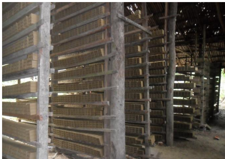
Figura 9: Tijolos secando ( outubro de 2012)
