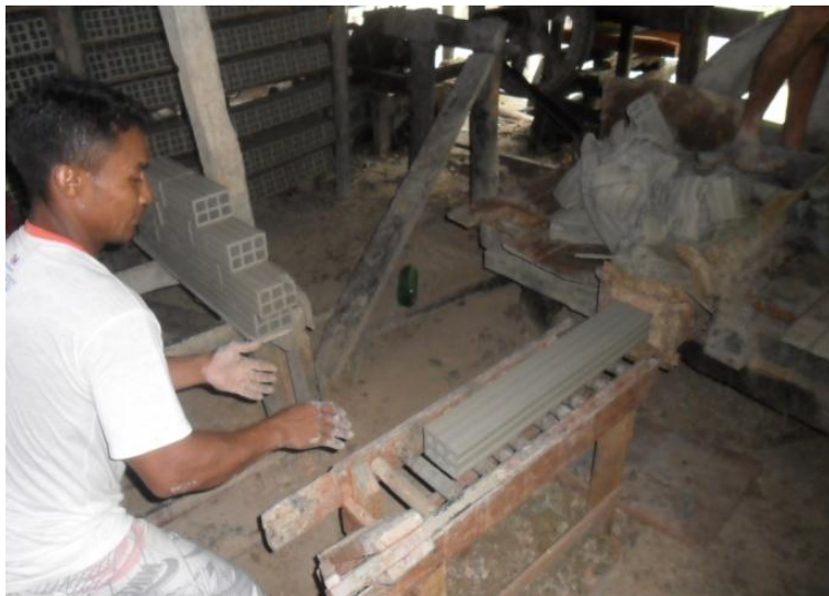
Figura 8: O barro sendo moldado pela maromba (outubro de 2012)
