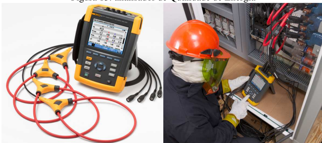
Figura 13: analisador de Qualidade de Energia
