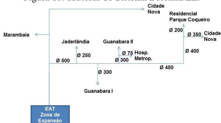
Figura 61: adutoras do Sistema Bolonha/ZE.
