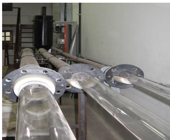
Figura 3. 5 -Vista dos tubos de vidro. A jusante aparece os tubos de PVC, coletor de partículas e filtro. Fonte: GEPAM-UFPA.
