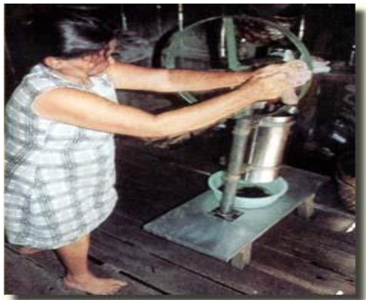
Figura 5: Processo de despulpamento do açáí em máquinas manuais na década de 1940. Fonte: Acervo do Autor
