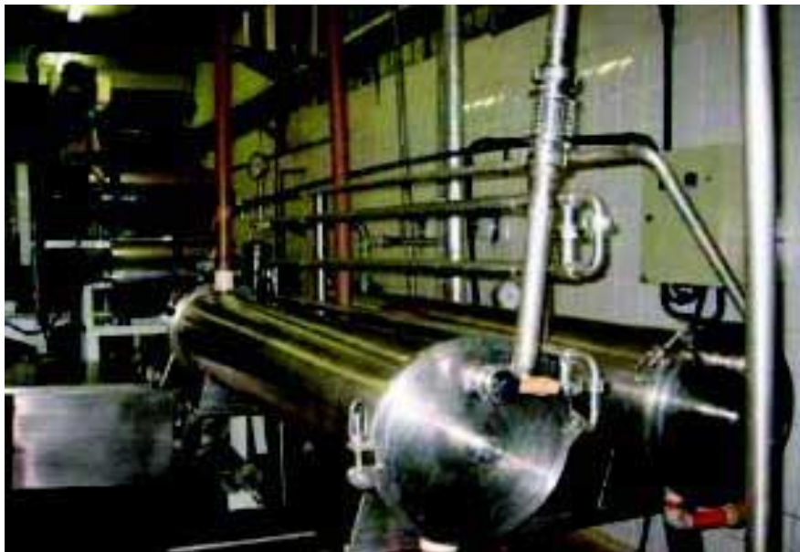
Figura 15: Pasteurizador para tratamento microbiológico de açaí. Fonte: Poema/UFPA (s/d)
