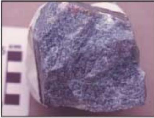
Fig. 7.5 - Granitoide alterado (sericita, pirita, carbonato) encaixante do minério aurífero no depósito Areal. Escala em cm.
