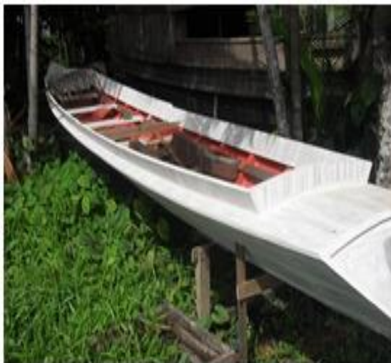
Figura 13: Rabeta em fase de construção
