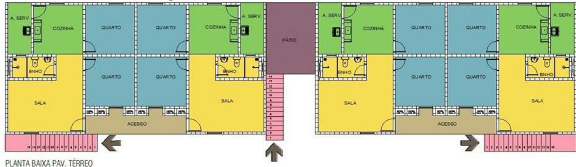
Figura 14 - Planta unidade térrea – Modelo P.
