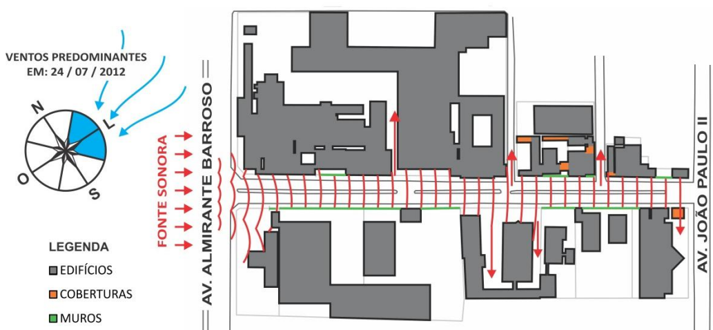
Figura 66 – Esquema de propagação do som (T2).
