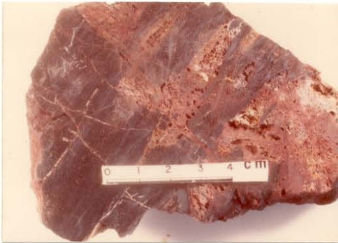
FIG. 11. Núcleo castanho avermelhado, compacto, terroso, contendo mineral negro, de brilho semi-metálico , fraturado. Amostra coletada nas escarpas da chapada do Pirocaua (MA)
