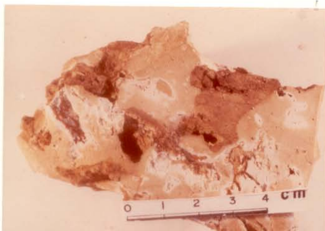
FIG. 6. Núcleo de material cinzento, compacto, poroso, sendo os poros preenchidos por material amarelado; dispersos pelo conjunto aparecem diminutos núcleos de material escuro. Amostra coletada no horizonte fosfático de Pirocaua (MA)
