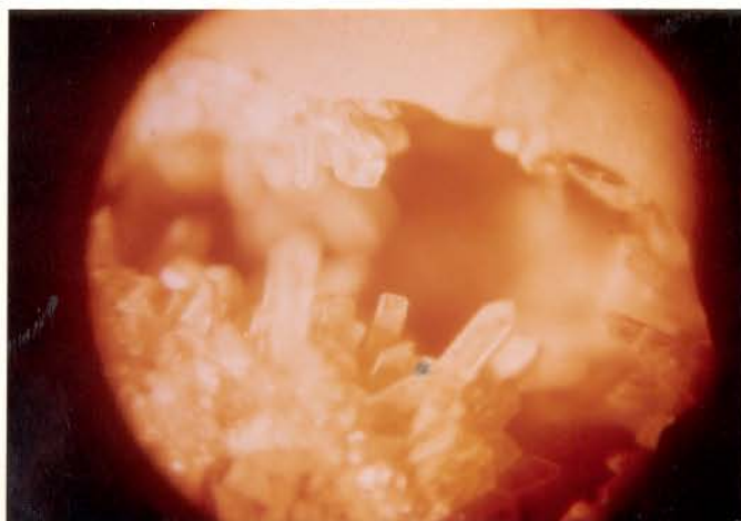
FIG. 13. Cristais milimétricos, incolores, brilhantes, preenchendo pequenas drusas existentes em material branco-amarelado (foto obtida com auxílio de microscópio). Amostra coletada no horizonte fosfático de Pirocaua (MA)
