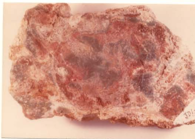
FIG. 10. Núcleo contendo material cinza, oolítico, material avermelhado e minerais de coloração verde-oliva e verde-azulada, bem como algumas alterações amareladas. Amostra coletada nas camadas superficiais do horizonte fosfático em Jandiá (PA)
