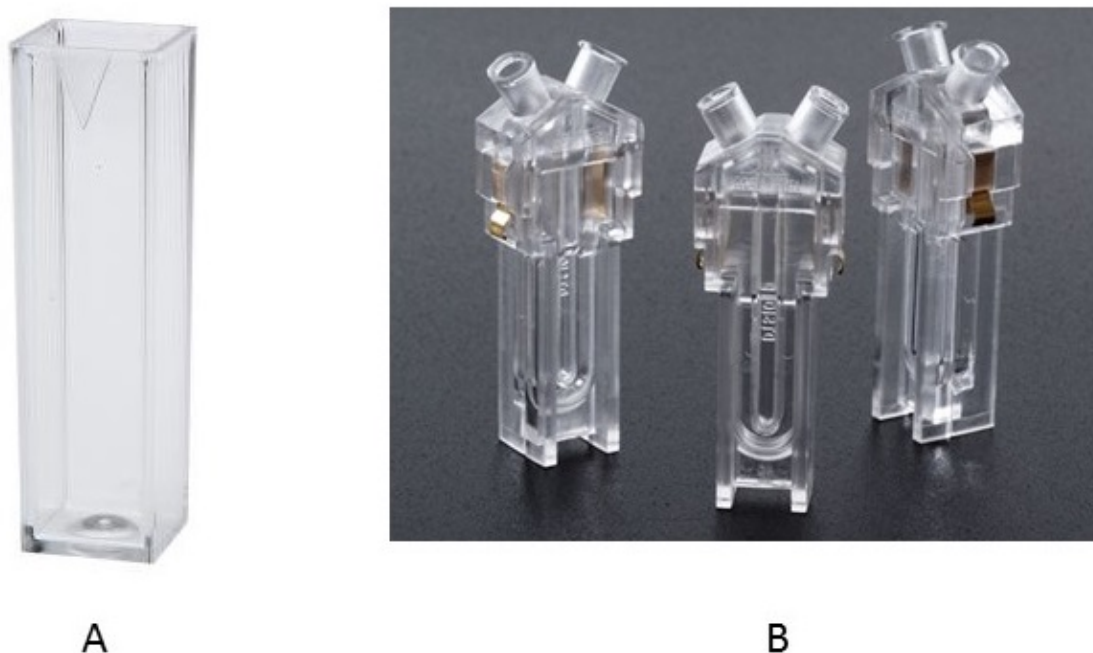
Figura 20: A: Cubeta de poliestireno; B: Cubeta de análise de Potencial Zeta.
