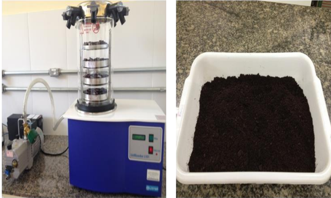
Figura 8 Liofilizador utilizado e polpa liofilizada obtida
