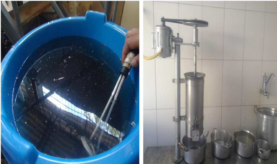
Figura 7. Amolecimento da polpa e despoldadeira de açai utilizada
