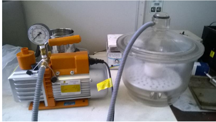
Figura 4.2 – Remoção de bolhas de ar a vácuo da solução de PVCP.
