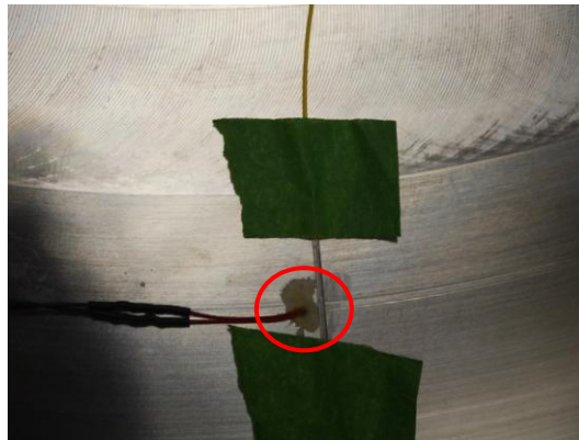
Figura 6.34 - Termistor instalado no tambor de aço.
