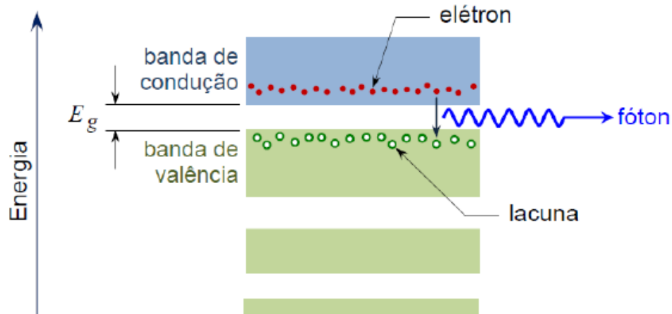
Figura 3.2 - Bandas de energia e princípio da emissão de luz por um semiconductor.
