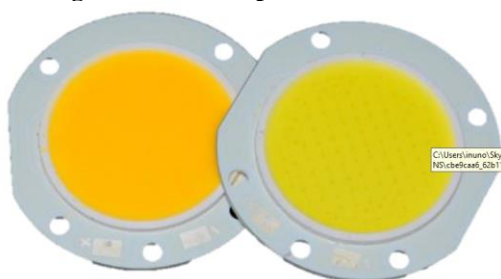
Figura 3.6 – Exemplo de COB LED.
