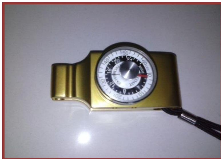
Fig. 11- Instrumento para avaliação da força de pinça Dinamômetro Preston Pinch Gauge ® . Fonte: Autor da pesquisa
