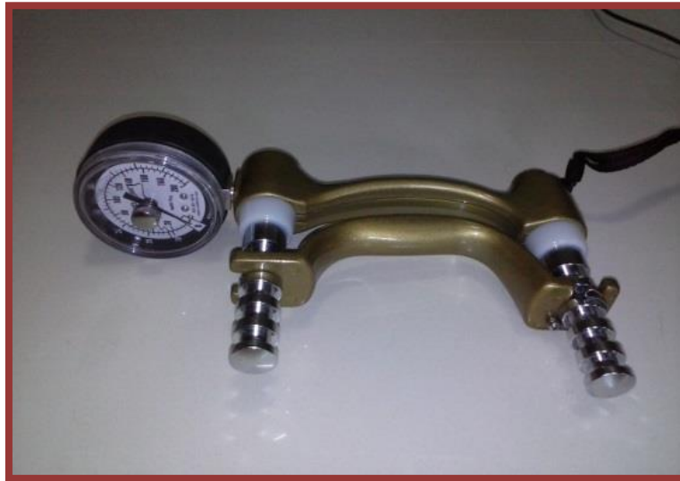
Fig. 10- Instrumento para avaliação da força de preensão Dinamômetro de Jammar ® . Fonte: Autor da pesquisa
