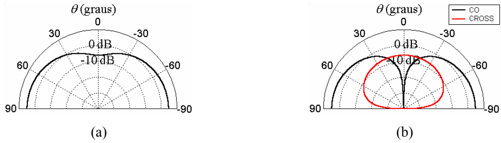
Fig. 4.10: Diagramas de radiação do MER de L_0=0,9L , K_f=0,9 e N_s=1 . A frequência de cada monopolo é a primeira ressonância. (a) plano xz ( \phi=0^\circ ). (b) plano yz ( \phi=90^\circ ).
