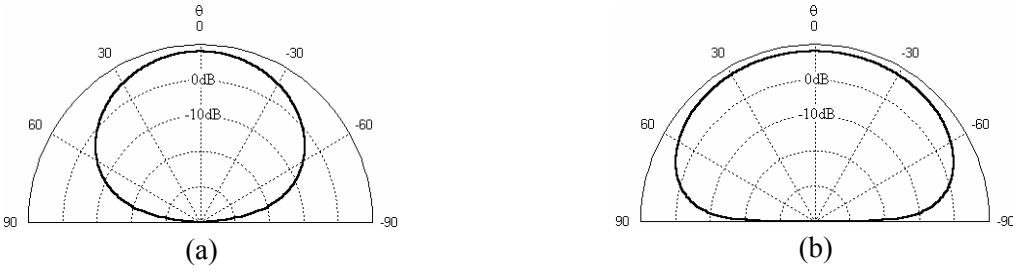
Fig. 7.10: Diagramas de radiação da antena Caso 1 quadrada em L_d/\lambda_c=0,85 . (a) Plano xz . (b) Plano yz .
