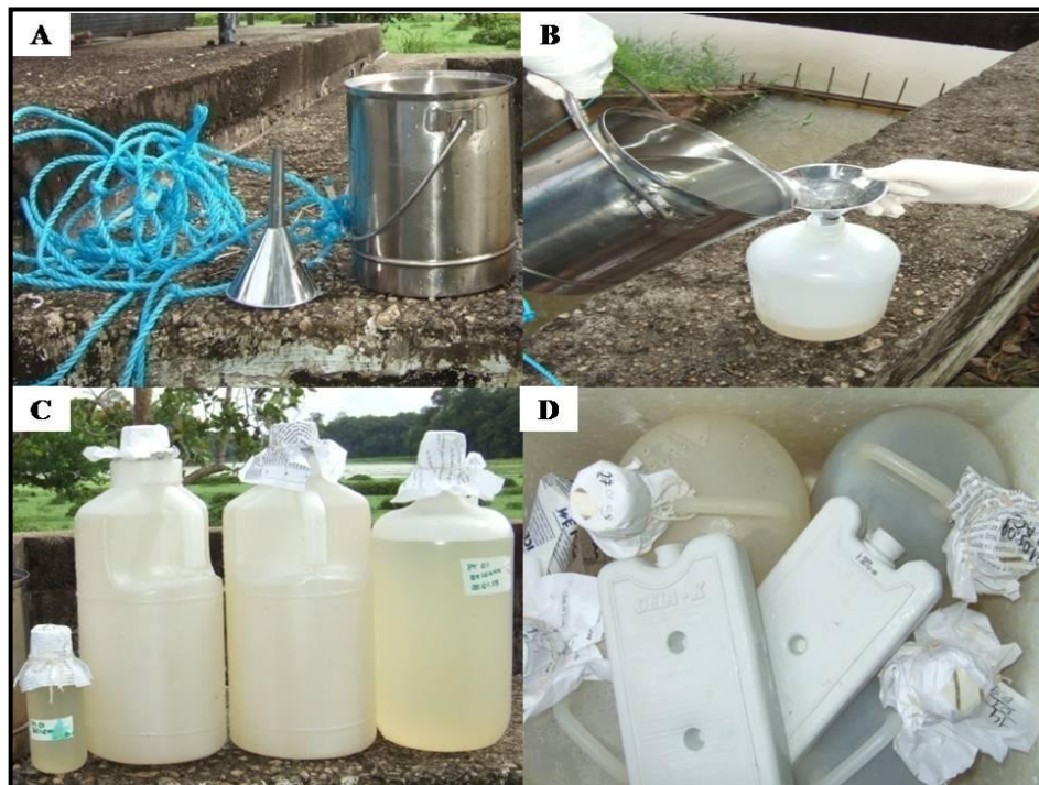
Figura 7. Materiais necessários para a coleta de água e egoto. Corda, funil e balde estéreis (A); armazenamento da amostra em frascos de polipropileno esterilizados (B e C); acondicionamento dos frascos contendo a amostra em isopores (D).
