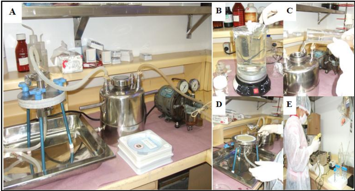
Figura 8. Processo de concentração aplicado nas amostras após a coleta. Conexão dos equipamentos, da direita para a esquerda bomba à vácuo, vasilhame de pressão e filtro (A); adição de MgCl_2 e ajuste do pH (B); volume de 2L de amostra é colocado no vasilhame (C); adsorção à membrana das possíveis partículas virais presentes na amostra (D); Lavagem e eluição da membrana (E). Fotos do arquivo pessoal.
