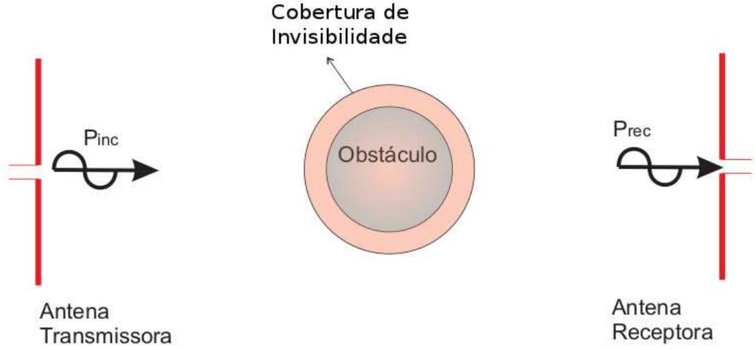
Figura 2.4: Quando o obstáculo é envolvido por uma camada de camuflagem o espalhamento é removido completamente.
