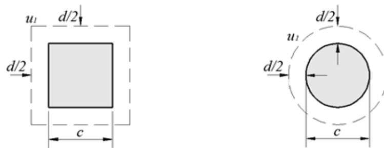
Figura 2.13 - Modelo para verificação da resistência à punção do (ACI 318, 2014).
