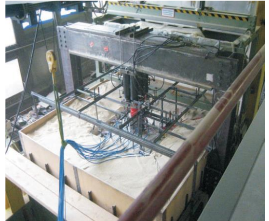
d) sistema com caixa de areia
