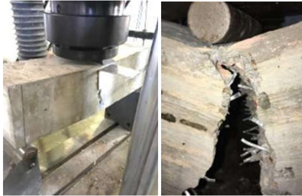
Figura 4.11 – Ensaio de flexão em 3 pontos do prisma de CRFA.
