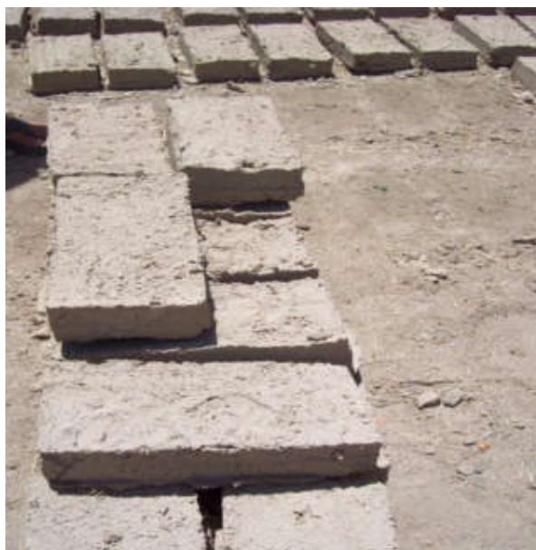
Figura 2.1 – Produção de tijolos adobe, com utilização de palha como fibra (CARVALHO et al. , 2010).
