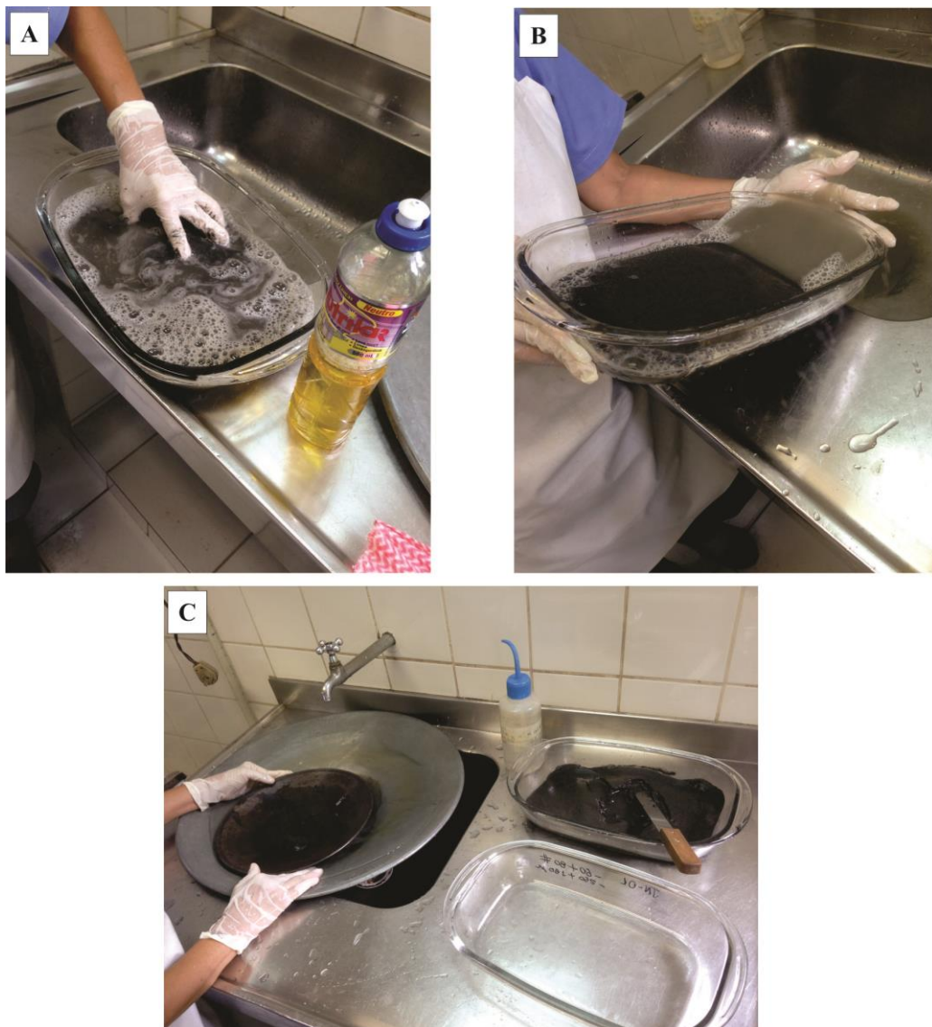
Figura 2 – Etapas da fase de bateamento: A) Processo de mistura da amostra com água e detergente para deslamar; B) Retirada do material argiloso em suspensão; C) Batéias sobrepostas, com a maior cheia de água. Retirada da amostra do pirex com espátula inox para a batéia menor.
