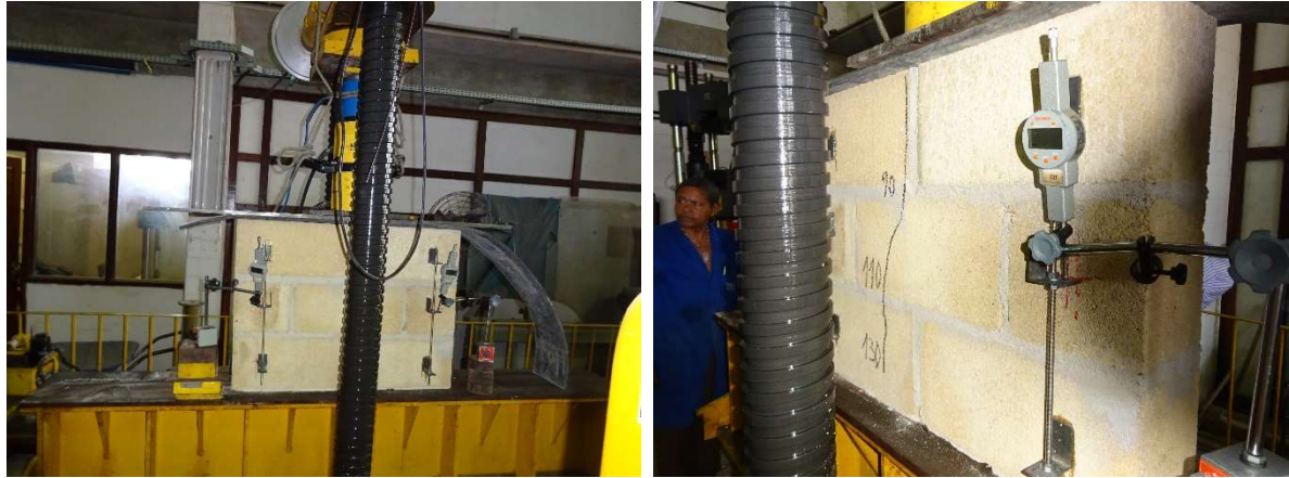
Figura 48 – Início de ruptura das minis paredes sentido vertical superior para inferior.
