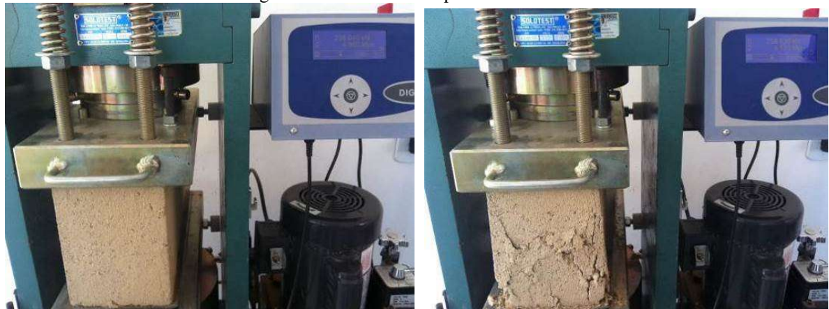
Figura 35 – Ensaio de compressão dos blocos.
