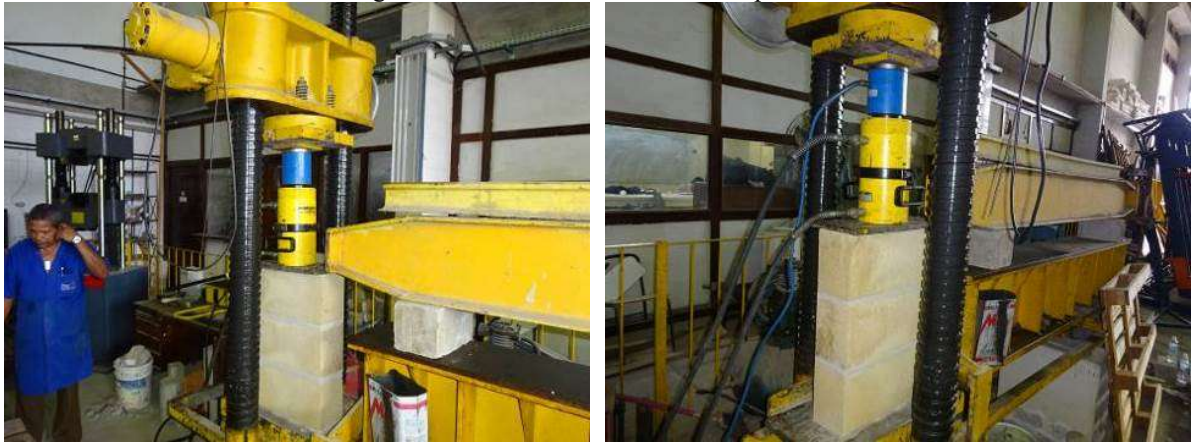
Figura 37 – Ensaio de resistência dos prismas.
