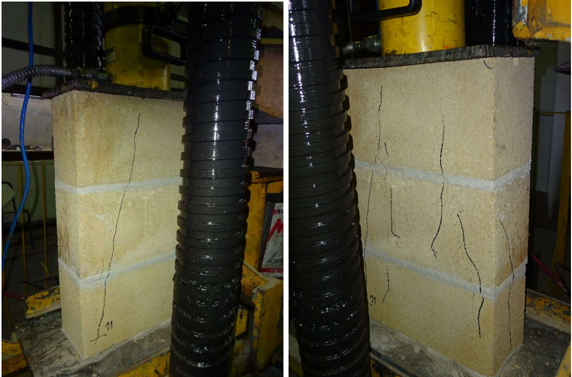
Figura 46 – Detalhe das fissuras dos prismas.
