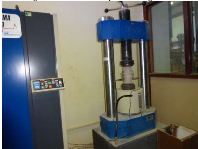
Figura 45 – Ensaio de compressão da argamassa.
