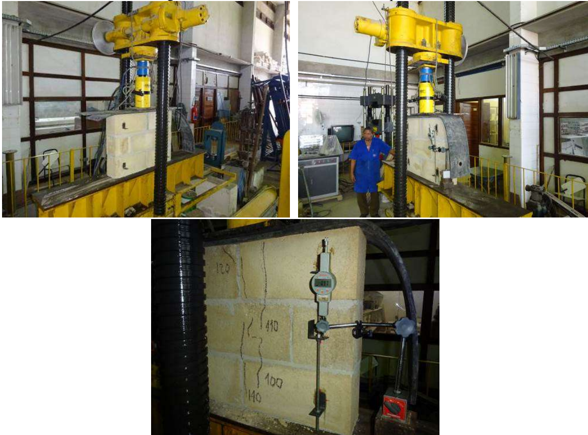
Figura 39 – Ensaio de resistência das mini paredes.
