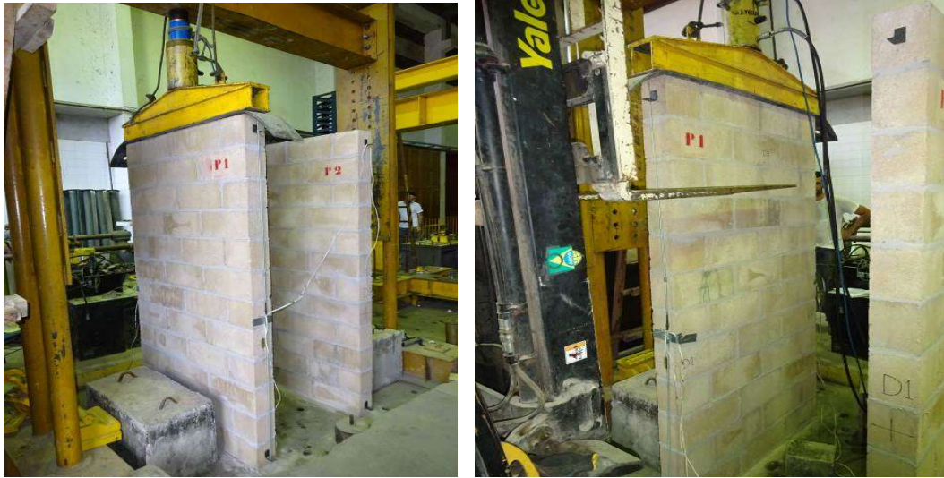
Figura 42 – Ensaio de resistência das paredes.
