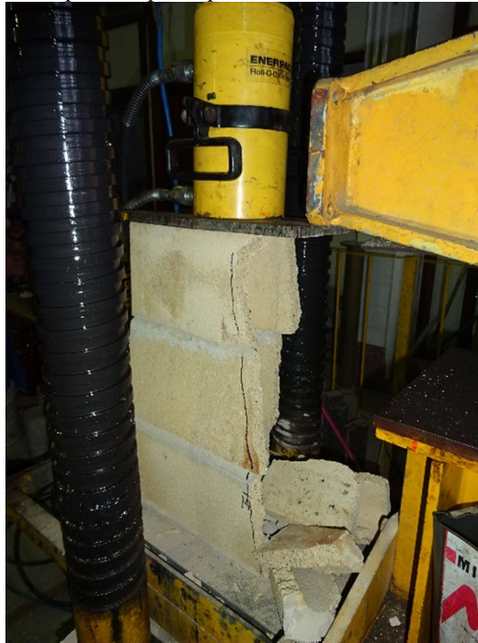
Figura 47 – Detalhe do prisma após ruptura com início no bloco superior ao inferior.
