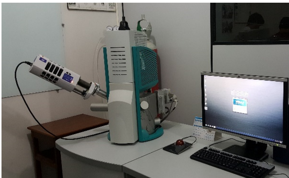
Figura 4.3 - Equipamento de utilizado para caracterização microestrutural: microscópio de bancada eletrônico de varredura.
