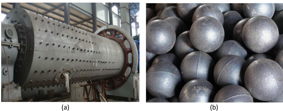
Figura 3.2 – Forno rotativo utilizado na redução da granulometria do resíduo de silício: (a) vista externa e (b) esferas de aço utilizados.
