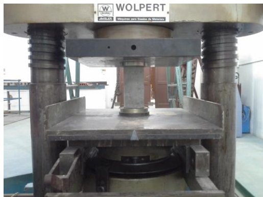
Figura 3.46 - Ensaio de compressão do concreto
