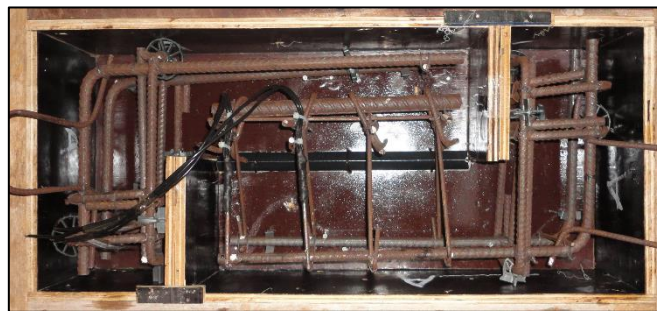
Figura 3.38 - Armadura do espécime Wc
