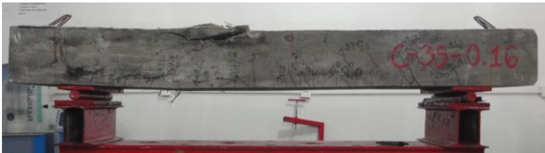
c) Viga após o ensaio
