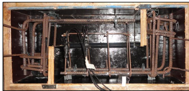
Figura 3.36 - Armadura do espécime W
