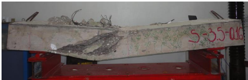
c) Viga após o ensaio
