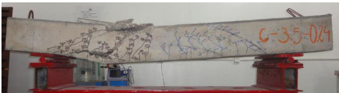
c) Viga após o ensaio
