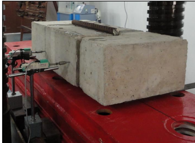
Figura 3.42 - Pré-fissuração do push-off
