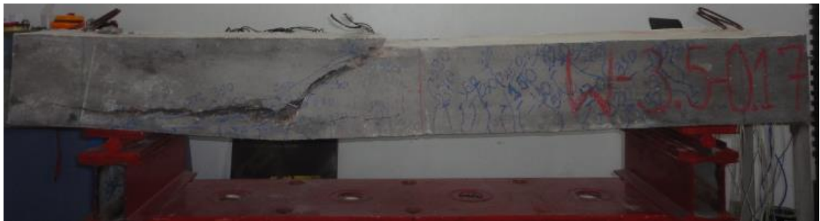
c) Viga após o ensaio
