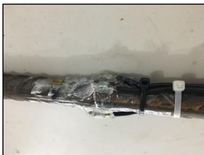
Figura 3.19 - EER colados na barra de flexão
