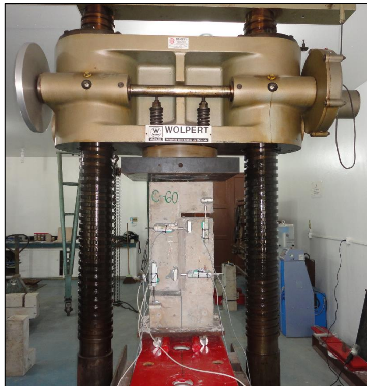
Figura 3.43 - Sistema de ensaio do push-off
