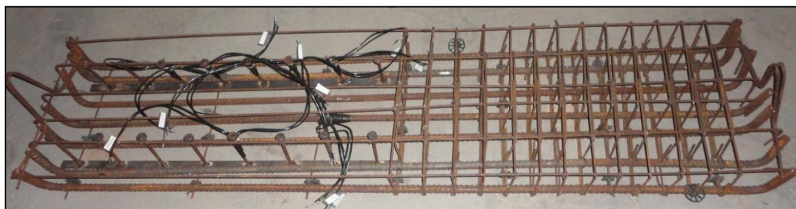
Figura 3.7 - Armadura da viga S-3.5-0.16
