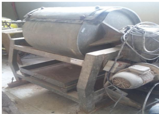
Figura 9 - Máquina de abrasão Los Angeles.
