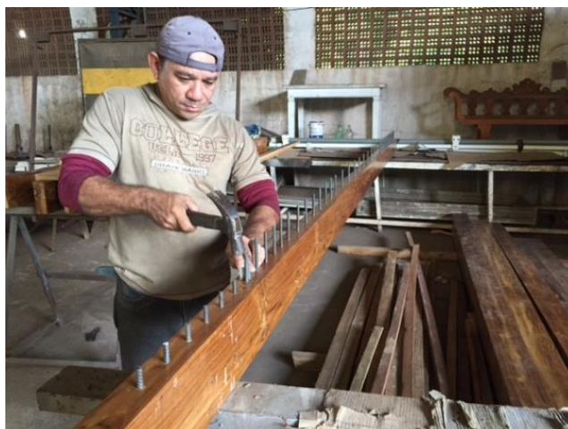
Figura 57 - Conectores em Fixação V5 a V12
