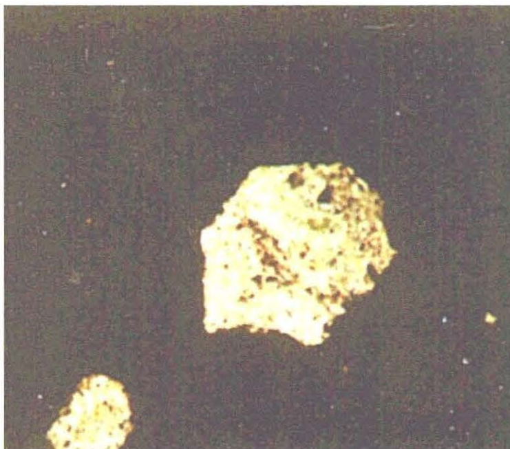
Figura 8.35: Cristal de quartzo em matriz de hematita/caulinita. Nicóis paralelos. Amostra 109.797.
