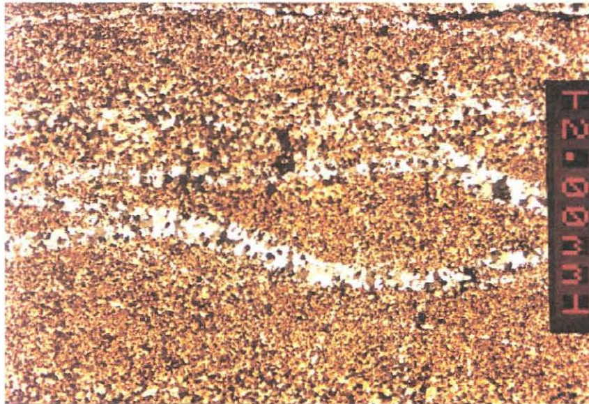
Figura 8.4: Jaspe, sob nicóis cruzados, mostrando os micro-cristais de quartzo. Amostra AJ-02.
