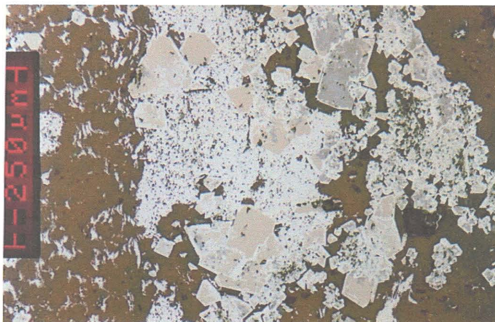
Figura 8.9: Cristais de magnetita (canto superior direito) com as bordas substituídas por hematita.
