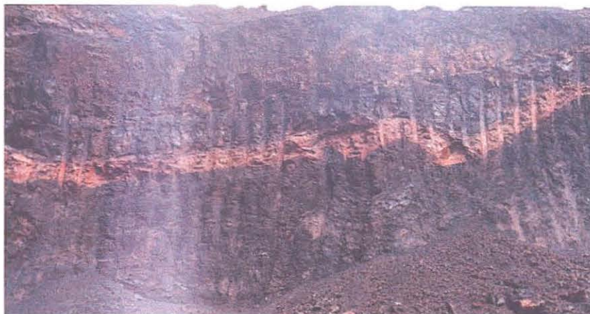
Figura 5.11: Sill de rocha máfica, com cerca de 1 m de espessura, alterado intempericamente e dobrado juntamente com o acamamento do minério.
