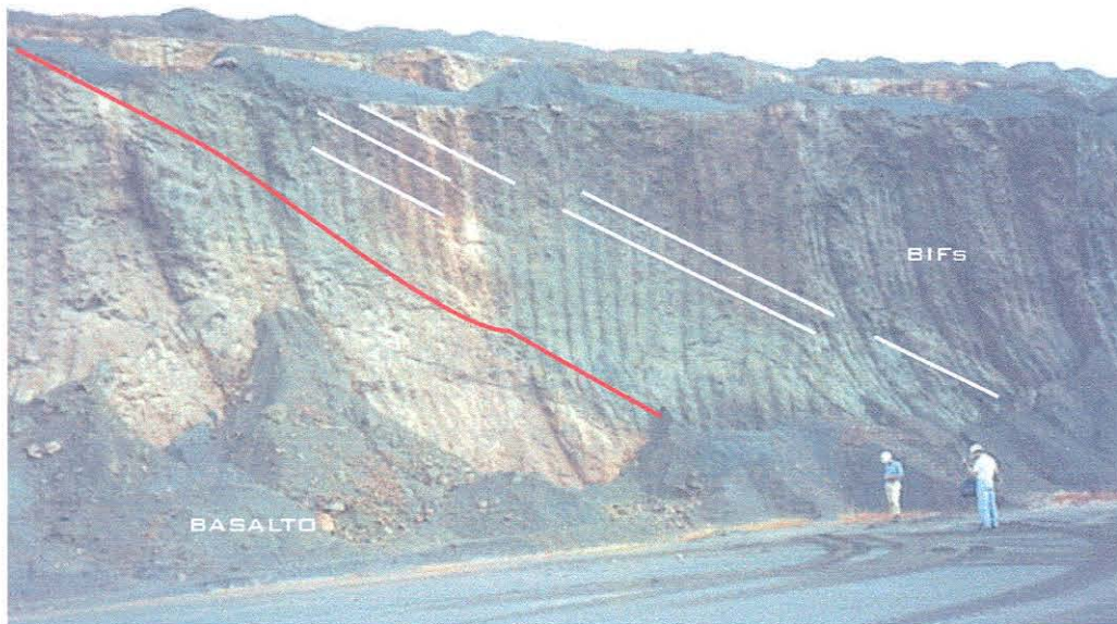
Figura 5.8: Situação concordante entre os planos do acamamento do minério (linhas brancas) e a superfície de contato com os basaltos da Formação Parauapebas na mina N4E (linha vermelha).
