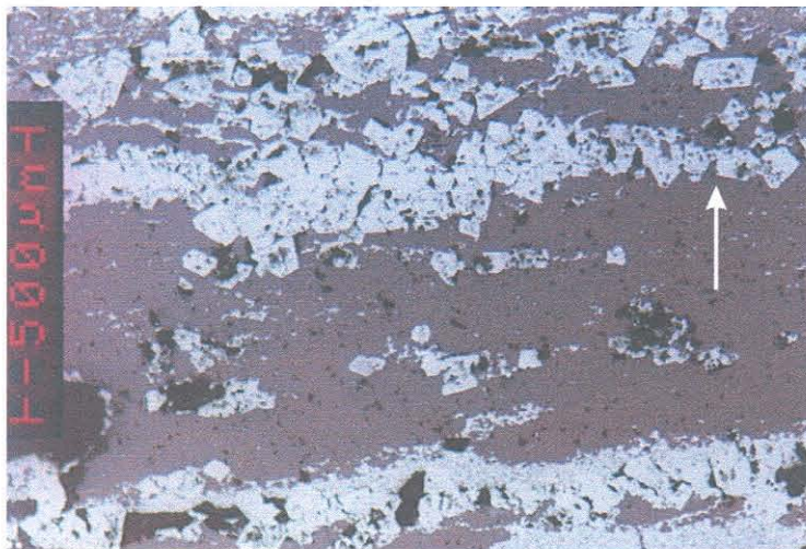
Figura 8.8: Cristais eudrais de magnetita/hematita alinhados paralelamente ao bandamento, indicados pela seta.
