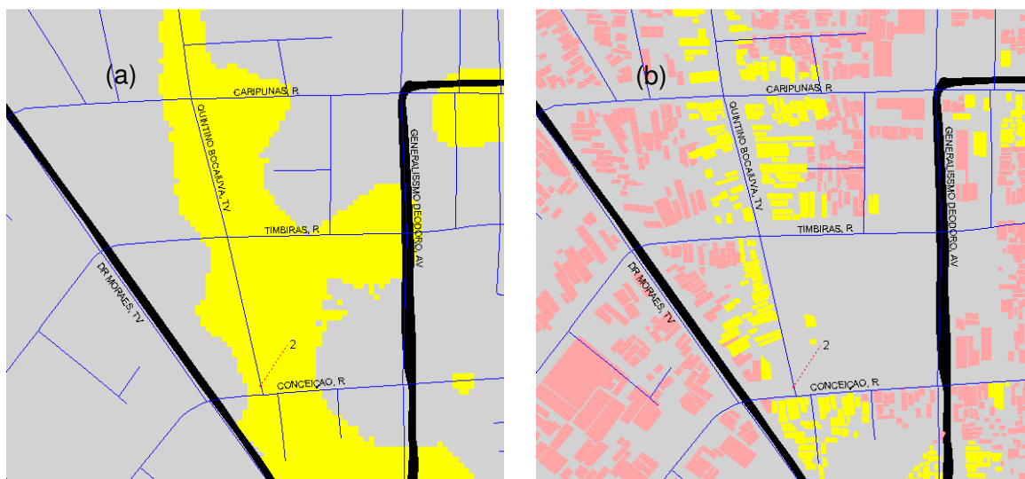
Figura 68. Ponto de alagamento (2) detectado através da simulação gerada no sistema de modelagem de risco, onde (a) representa a provável área de abrangência e (b) as prováveis edificações afetadas.
