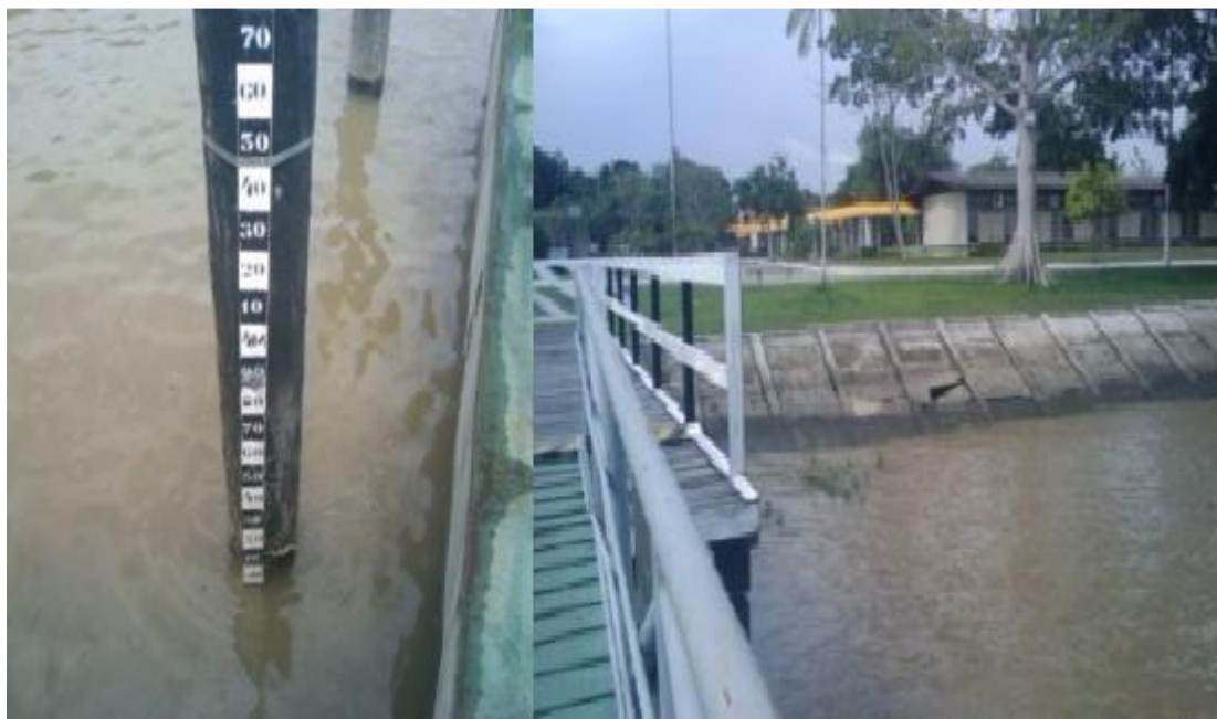
Foto 4. Localização da régua linimétrica instalada no Rio Guamá próximo a restaurante (R8) da UFPA.
