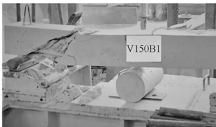
Figura 4.34: 4.9: Aspecto das vigas V150S, V150B0 e V150B1 após os ensaios. Fonte: Autora
