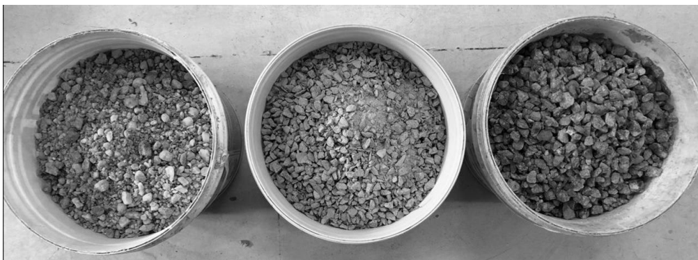
Figura 3.20: Seixo, brita 0 e brita 1 utilizados na pesquisa. Fonte: Autora
