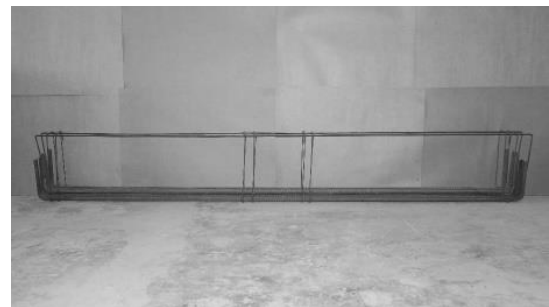
(a) (b) Figura 3.6: Detalhamento das armaduras das vigas com seção (150 x 450) mm
