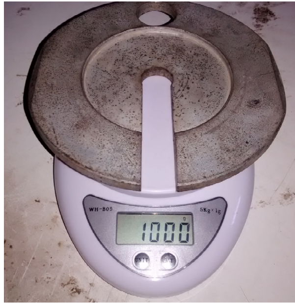
Figura 6.3: Balança mostrando que o valor da massa é exatamente 1Kg, de um dos pesos-padrão.
