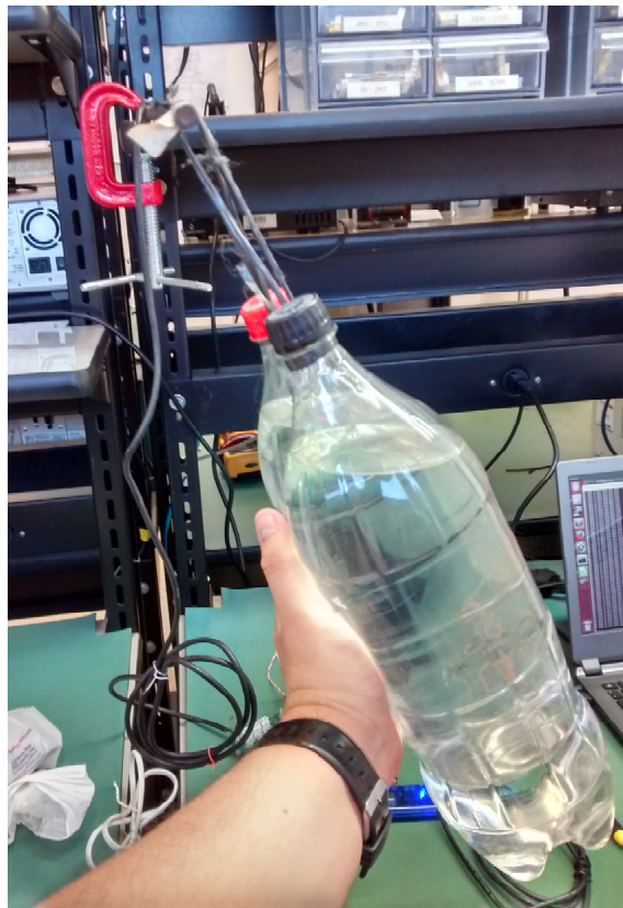
Figura 6.7: Teste de oscilação da massa, para provocar uma deformação variável.
