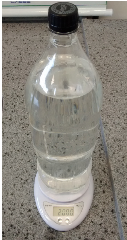
Figura 6.5: Balança mostrando o valor da massa de exatamente 2Kg, de um dos pesos-padrão.
