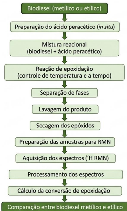
Fluxograma 4.1 - Procedimento experimental para epoxidação e análise por RMN de biodiesel metílico e etílico.
