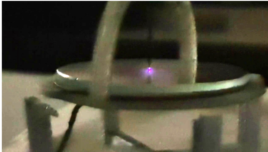
Figura 21 – Fotografia da descarga parcial entre a ponta da agulha e a barreira de vidro, registrada em ambiente escuro.
