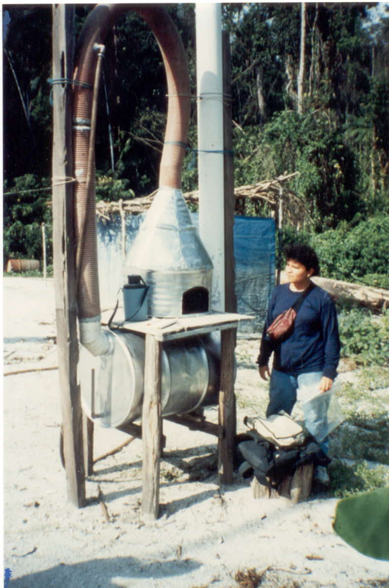
Anexo 18: Queimador/retorta para queima do amálgama Hg-Au e recuperação do mercúrio, no ig. Fé em Deus.
