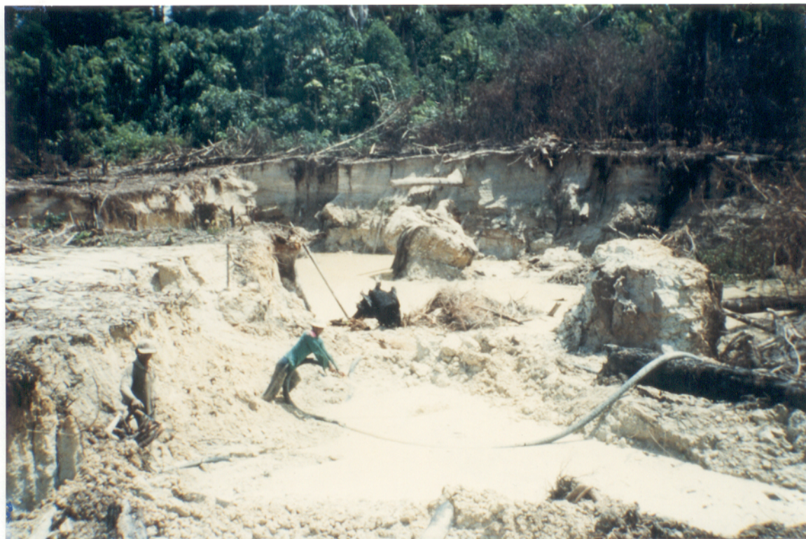
Anexo 7: Desmonte hidráulico com “chupadeira” do barranco em um dos garimpos de baixão.
