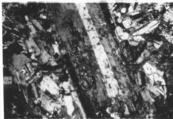
Figura 34 - Fotomicrografia onde se observa fenocristal de plagioclásio com zoneamento normal, além de feições de corrosão, imerso numa matriz subofítica tendendo a granular em quartzo-diorito pórfiro (RJ-33A, NC).
