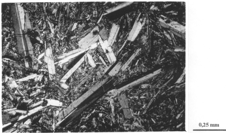
Figura 25 - Fotomicrografia mostrando textura intergranular formada por ripas de plagioclásio entremeadas com restos de piroxênio e fases secundárias. Textura característica das porções mais finas do anfibólio diabásio. (RJ-42C, NC).
