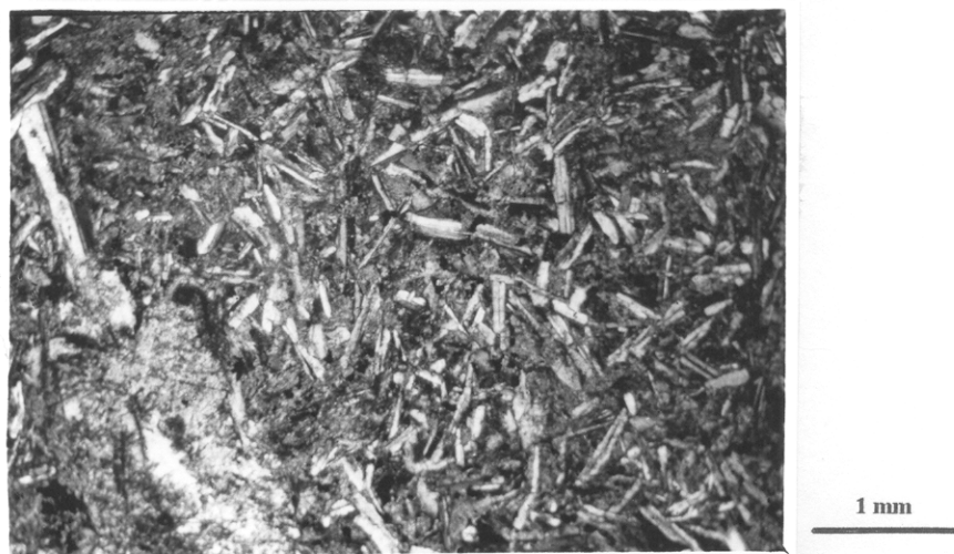
Figura 26 -.Fotomicrografia revelando textura microporfirítica com fenocristais de plagioclásio, imersos em uma matriz intergranular encontrada geralmente nas porções próximas da borda do dique de diabásio com olivina (RJ-12C, NC).
