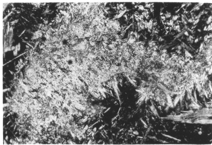
Figura 23 - Fotomicrografia mostrando detalhe da figura anterior, revelando pseudomorfos de piroxênio, constituído por agregado fibroso de tremolita-actinolita, feição dominante no anfibólio diabásio (RJ-29A, NC).
