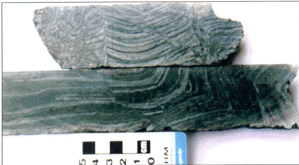
Figura 4.2-5- Fotografia de testemunhos de sondagem mostrando pequenos conjuntos de falhamentos dentro de uma sinemática dúctil-rúptil. Esses falhamentos são responsáveis pela reorganização de estruturas dobradas e foliadas.
