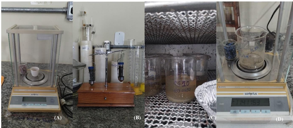
Figura 24- Etapas de laboratório. (A) Amostra sendo pesada na balança analítica; (B) Tubos de ensaio pesados a pares em balança de equilíbrio; (C) Amostra de silte secando na estufa; (D) Pesagem da amostra seca. Fonte: Autora.
