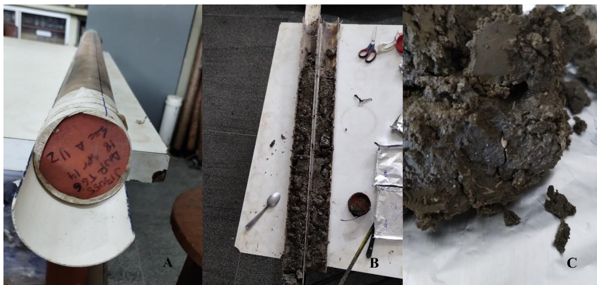
Figura 22- Abertura do testemunho T66. (A) Marcação da abertura no testemunho, com o uso de pilote e uma calha. (B) Separação do testemunho em duas partes longitudinais e fracionamento a cada 10 cm. (C) Amostra em detalhe com carapaças calcárias. Fonte: Autora.
