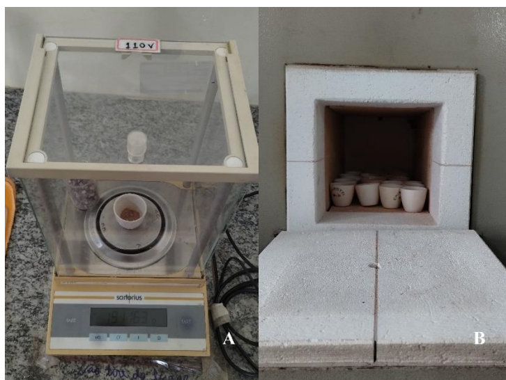
Figura 25- Etapa de queima e amostras secas. (A) Amostra sendo pesada na balança analítica; (B) Amostra na mufla prontas para a queima de MO e/ou \text{CaCO}_3 . Fonte: Autora.
