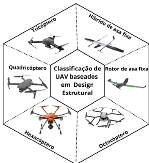
Figura 2 – Classificação de UAVs baseado na configuração de asas e funções operacionais.
