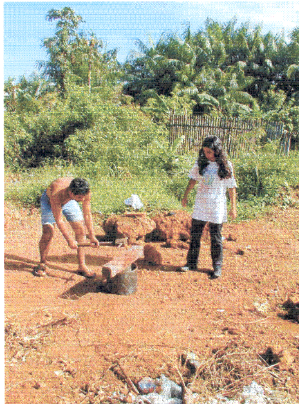
Figura 25- Ensaio de infiltração com cilindros concêntricos.
