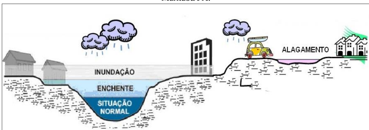
Figura 08- desenho esquem  tico da inunda  o, de como ocorre na   rea do rio Mocajatuba – Marituba/PA.
