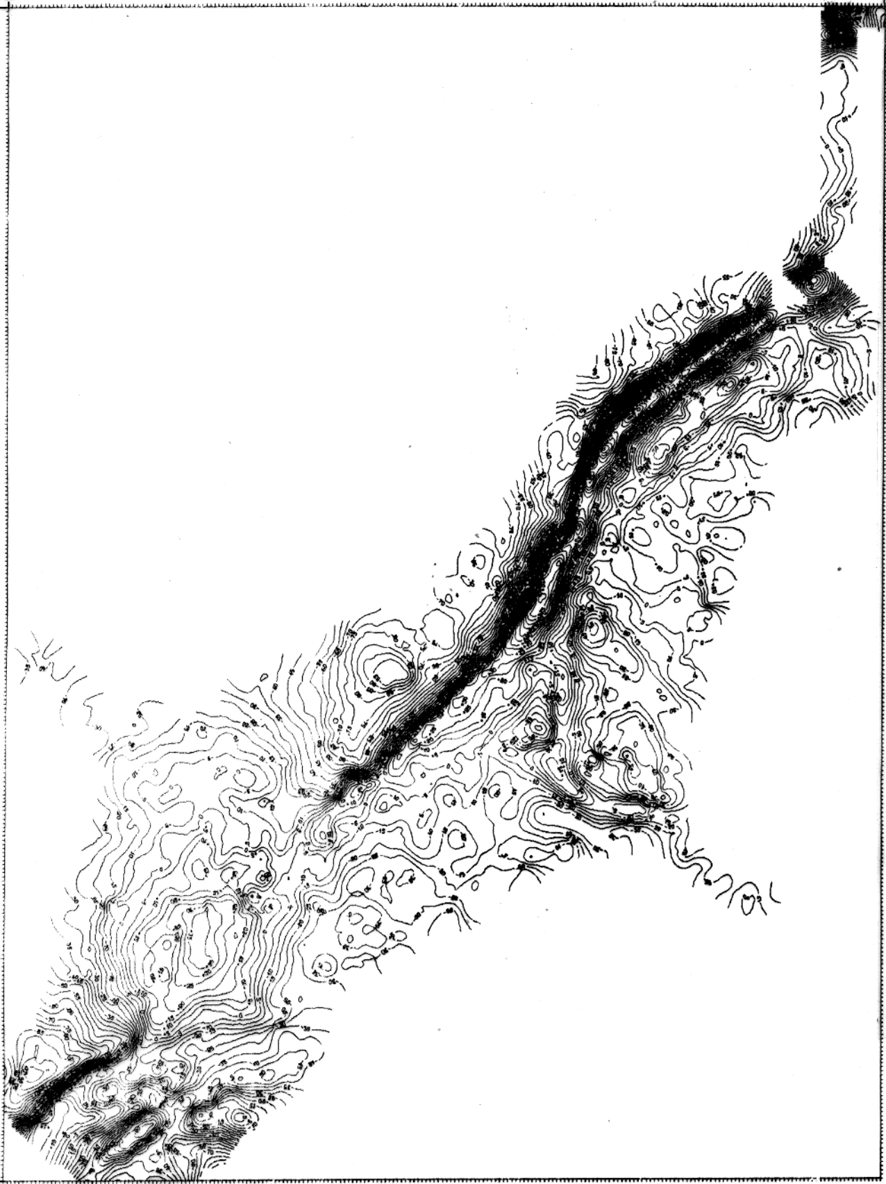
Figura 76- Aplicação 7 Mapa de contorno da anomalia ar-livre do Projeto Equant-2 interpolada pelo método da mínima curvatura. O intervalo de contorno é igual a 5 mGal.
