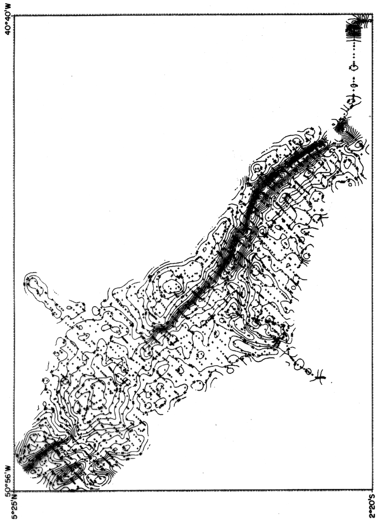
Figura 75- Aplicação 7 Sobreposição do mapa de contorno da Figura 74 com o mapa do posicionamento das ob- servações equivalentes. O intervalo de contorno é igual a 5 mGal.
