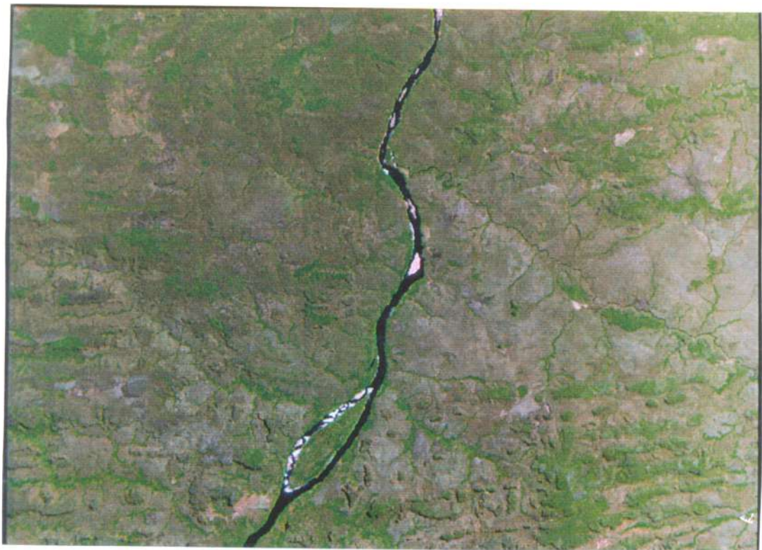
Figura 4.23 - Imagem do sensor TM do satélite LANDSAT-5, composição colorida 5R4G3B. Escala aproximada 1;250.000. Romboedro transtensivo desenvolvido pelo recobrimento de falhas dos Sistemas Transcorrentes Rio Feio e Mosquito Curicaca, com falhas do Sistema Transcorrente Carolina-Pedra Caída. Ao centro, descontinuidades de direção N-S integrantes do Sistema Distensivo Estreito São José.
