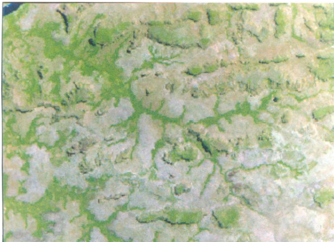
Figura 4.9 - Imagem do sensor TM do satélite LANDSAT-5, composição colorida 5R4G3B, escala aproximada 1:200.000. Sistema Transcorrente Carolina-Pedra Caída com as feições de relevo desenhando figuras geométricas em Z, evidenciando movimentação dextral.
