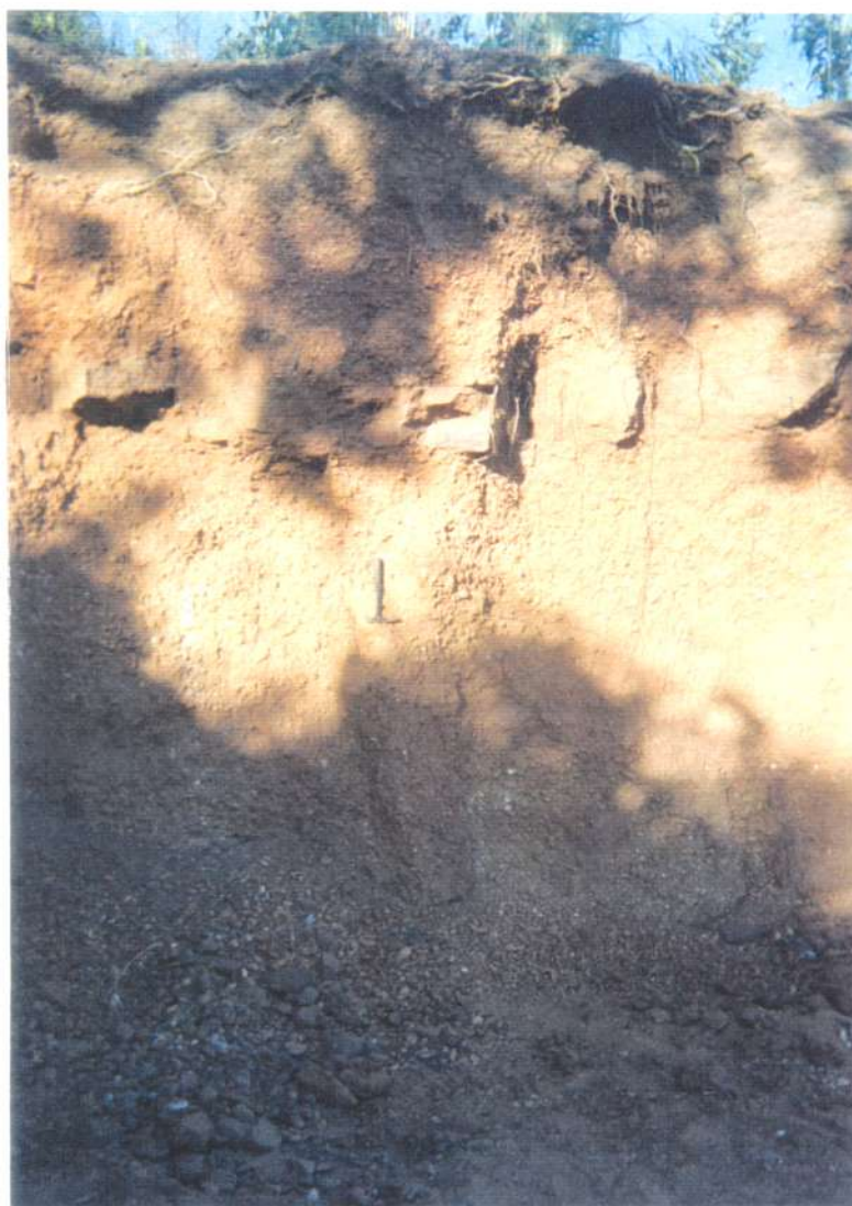
Figura 3.12 - Terraços do rio Tocantins, expondo material conglomerático matriz suportada, onde se faz a retirada de cascalhos para emprego em obras civis. O terraço indica surgimento recente da área com entalhamento do rio.
