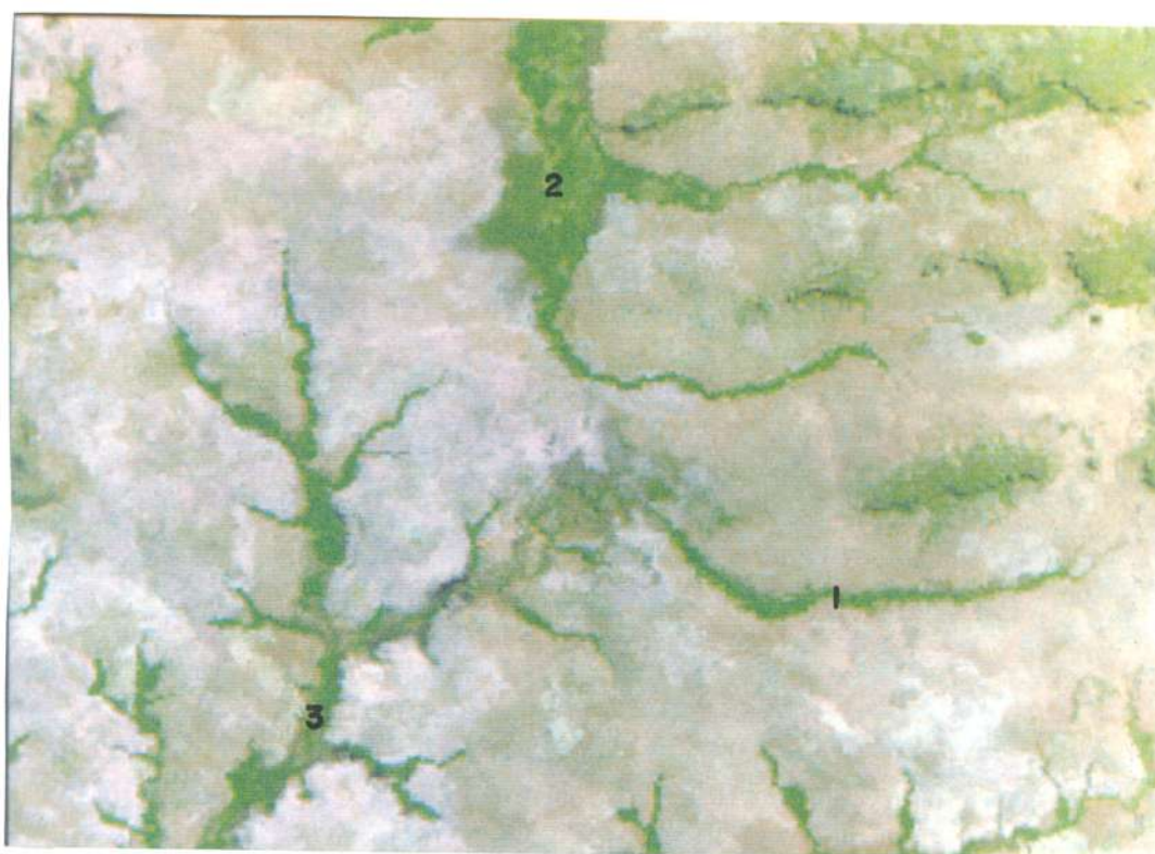
Figura 4.41 - Imagem do sensor TM do satélite LANDSAT-5, escala aproximada 1:100.000. Fenômeno de captura. Afluente -1- do Ribeirão Corrente -2- foi capturado pelo rio Itapecuru -3- devido a soerguimento ao longo do Sistema Transcorrente Carolina-Pedra Caída, situado na porção superior da foto (bacia do ribeirão Corrente), e rebaixamento da Zona Transtensiva Carolina-Pedra Caída, na parte inferior da foto.
