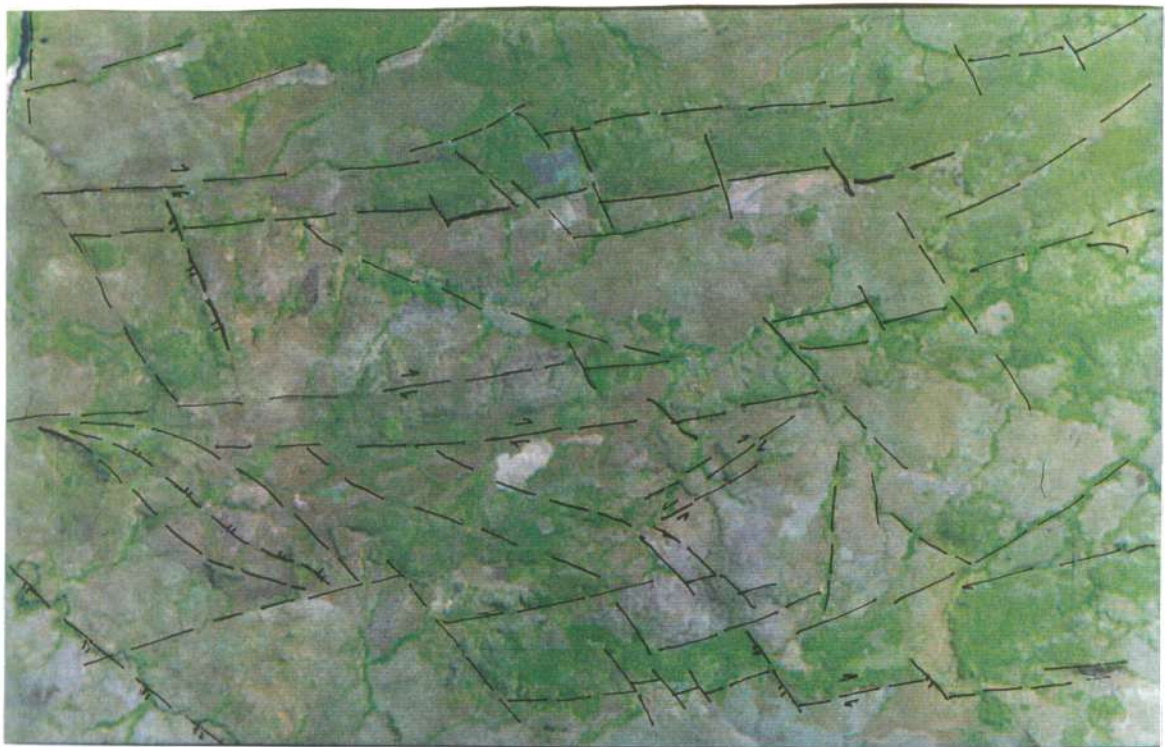
Figura 4.21 - Imagem do sensor TM do satélite LANDSAT-5, composição colorida 5R4G3B. Escala aproximada 1:200.000. Sistema Transcorrente Rio Feio, caracterizado por feixes de falhas transcorrentes dextrais com direção ENE-WSW, interagindo com falhas normais NW-SE.
