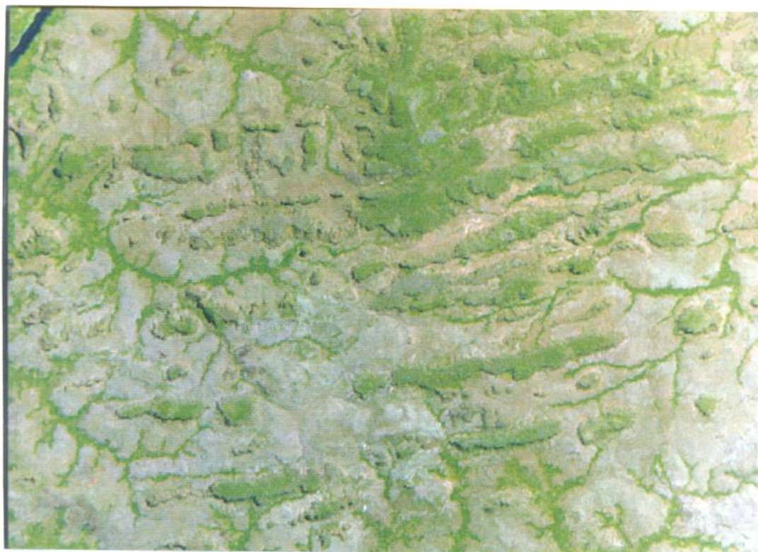
Figura 3.7 - Imagem do sensor TM do satélite LANDSAT -5, composição colorida 5R4G3B ; escala aproximada 1:200.000. Mesas e chapadas sustentadas por basaltos da Formação Mosquito orientadas ENE-WSW, com forte dissecação estrutural. A presença de solos eutróficos e distróficos sobre os basaltos, bem como a altitude das mesas propiciam o desenvolvimento da vegetação algo exuberante ( cor verde na imagem) contrastando com os tons claros onde ocorrem areias que formam áreas planas e rampas de colúvios, na base das formas de relevo.
