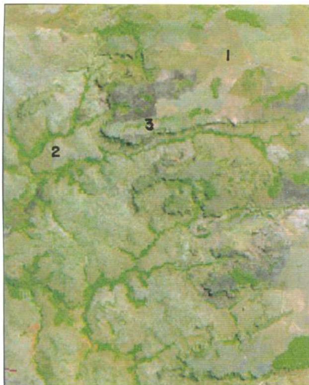
Figura 5.6 - Imagem do sensor TM do satélite LANDSAT-5, escala aproximada 1:400.000. Bordas do Planalto Soerguido Darcinópolis (1), desenvolvidas pelo recuo de escarpas associadas às falhas normais do Sistema Distensivo Wanderlândia. No bloco baixo encontra-se o Planalto Rebaixado Wanderlândia (2).. Notar em (3) a presença de marcas de paleodrenagem que vertia ao Araguaia anteriormente à movimentação neotectônica.
