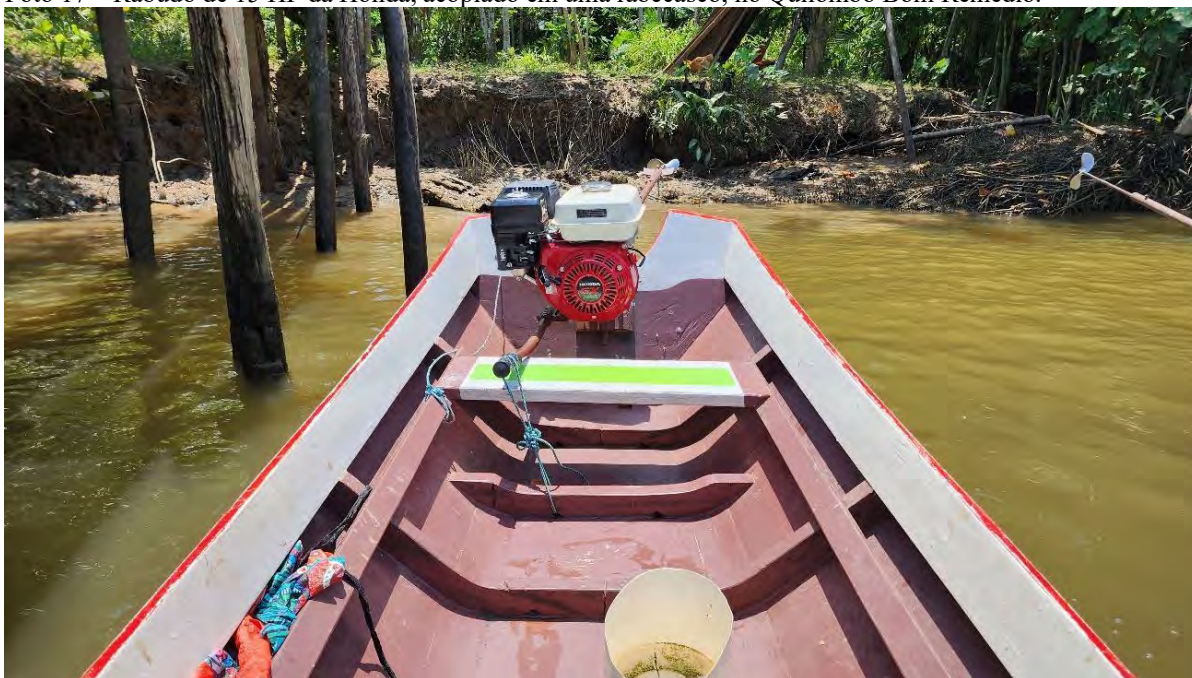
Foto 17 – Rabudo de 15 HP da Honda, acoplado em uma rabecasco, no Quilombo Bom Remédio.
