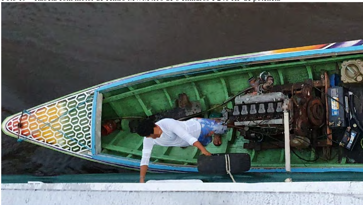
Foto 19 – Rabeta com motor de centro MWM x10 de 6 cilindros e 240 HP de potência
