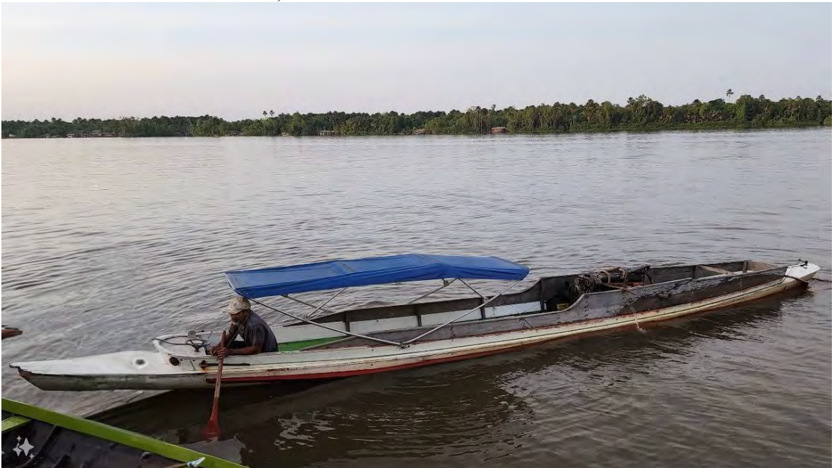
Foto 9 – Rabeta com motor de centro, na Vila do Pirizinho.
