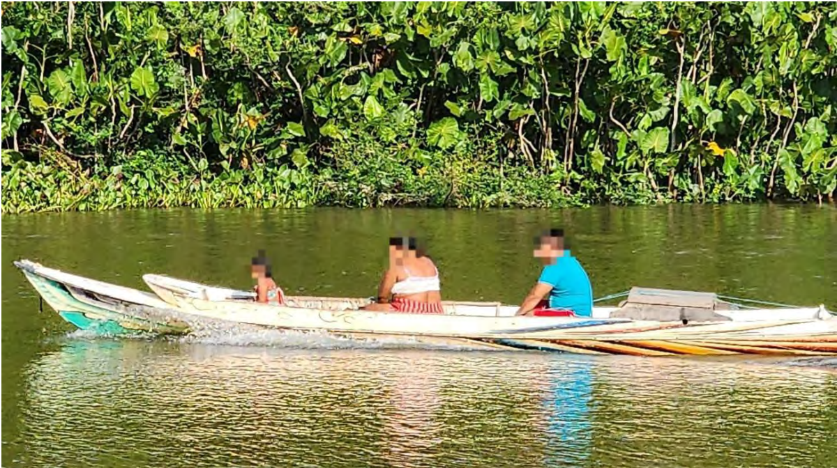
Foto 8 – Rabeta com motor de centro e sistema de leme por corda, transportando uma família, no Quilombo Bom Remédio.
