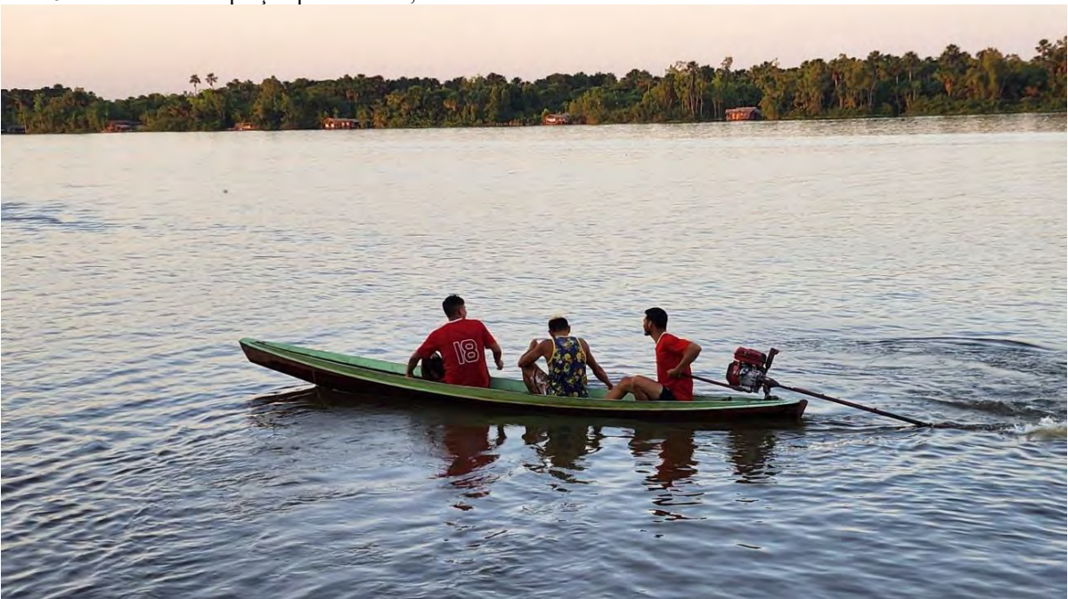
Foto 6 – Casco com adaptação para rabudo, na Vila do Pirizinho.
