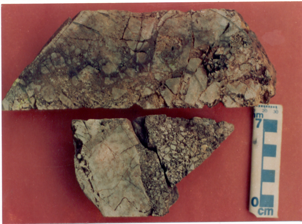
Figura 15- Textura brechada nas bordas de veios de quartzo, gerada por repetidos falhamentos do próprio veio, comumente encontrada no sistema Águas Claras. F-139/222,2 m.
