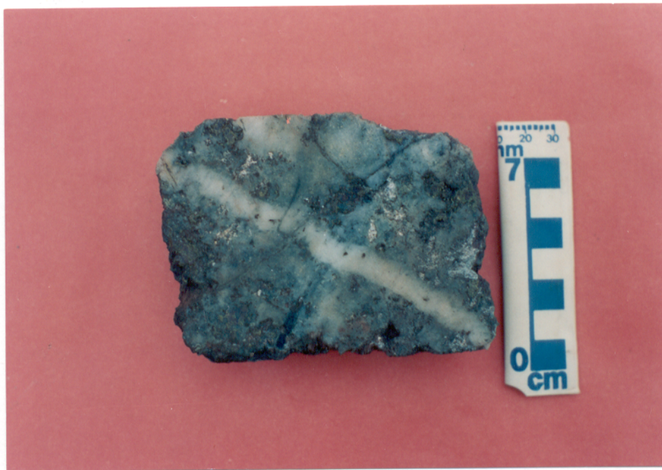
Figura 12- Vênula de quartzo leitoso cortando veio de quartzo translúcido com sulfeto associado, compondo a textura de quartzo fantasma. F-153/136,0 m
