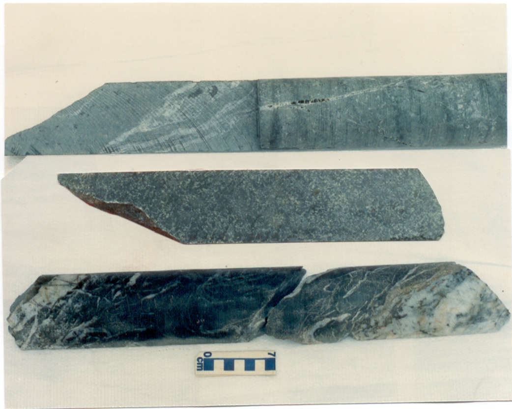
Figura 6-Rochas gabróicas de granulação variada, desde fina a grossa e textura ígnea preservada nos dois primeiros testemunhos. O primeiro é cortado por vênulas de quartzo com sulfetos e magnetita, enquanto que o último é densamente venulado por quartzo e clorita. Testemunhos de sondagem do F-139 com metragens iguais a 154,0, 162 e 218,0 m, respectivamente.
