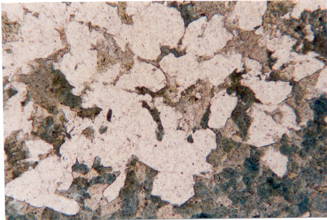
Figura 22- Fotomicrografia de turmalina entre os grãos de quartzo, como produto de alteração hidrotermal. Fotomicrografia em nicóis paralelos. F-125/66 m.
