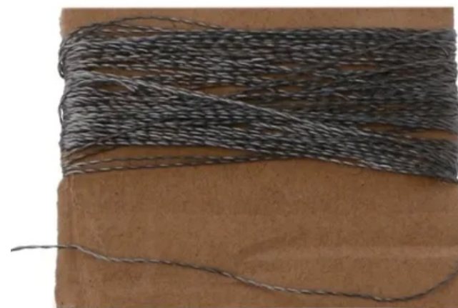
Tipo de linha condutora utilizada no carpete
