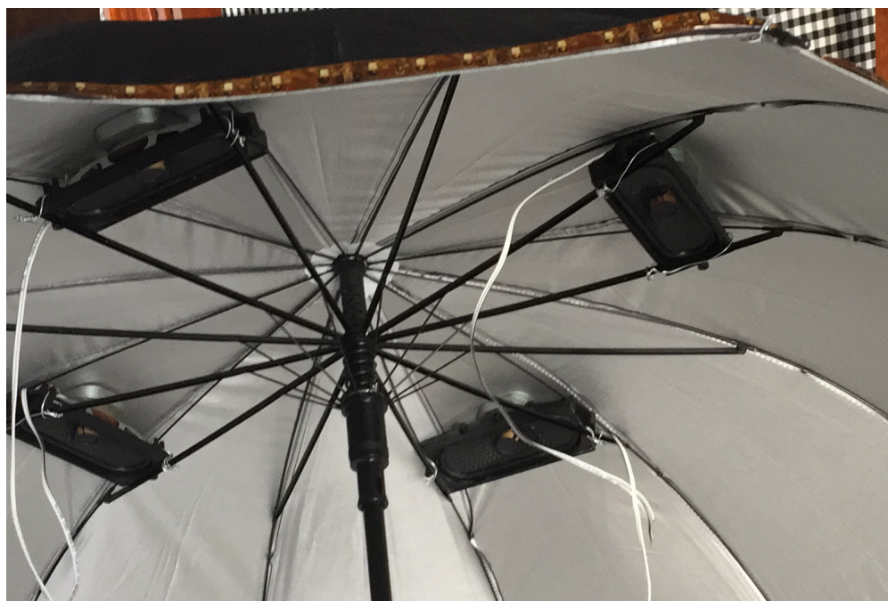
Parte interior do guarda-chuva com indicação provisória da posição dos alto falantes, esses modelos da imagem foram posteriormente substituídos por modelos mais leves.
