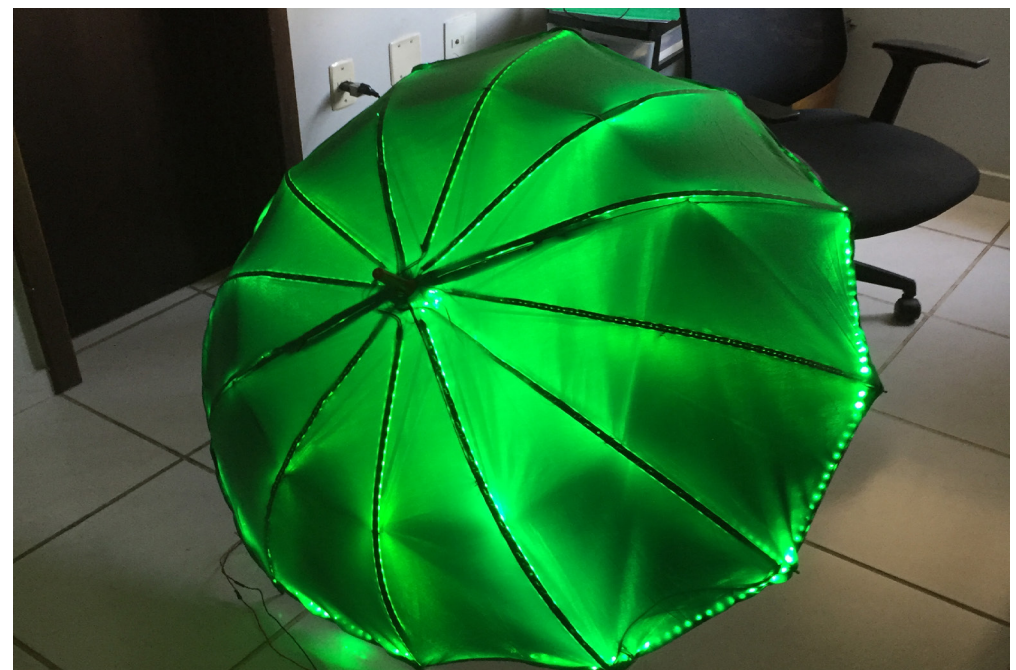
Teste do guarda-chuva em casa com os LEDs e os tecidos costurados a armadura de metal
